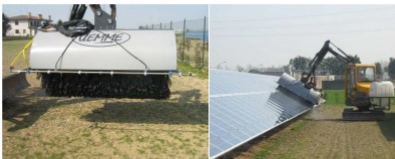
Figura: Dispositivo di pulizia moduli – Pulizia dei moduli
