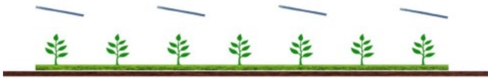
Figura 20: Sistema agrivoltaico in cui la coltivazione avviene tra le file dei moduli fotovoltaici, e sotto a essi (TIPO 1).
