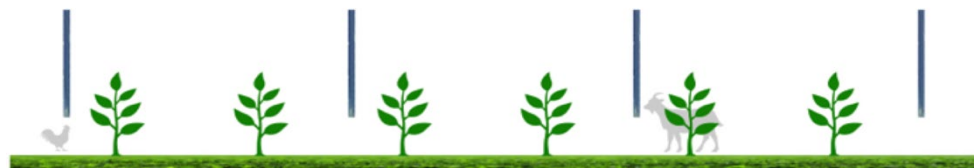
Figura 22: Sistema agrivoltaico in cui i moduli fotovoltaici sono disposti verticalmente. La coltivazione avviene tra le file dei moduli fotovoltaici, l'altezza minima dei moduli da terra influenza il possibile passaggio di animali (TIPO 3).
