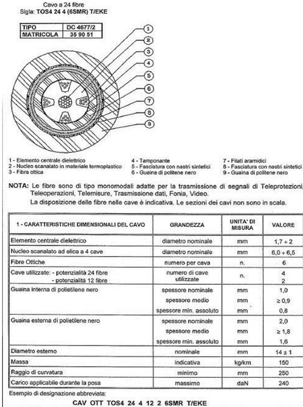
Figura 18: Scheda tecnica cavo in fibra ottica
