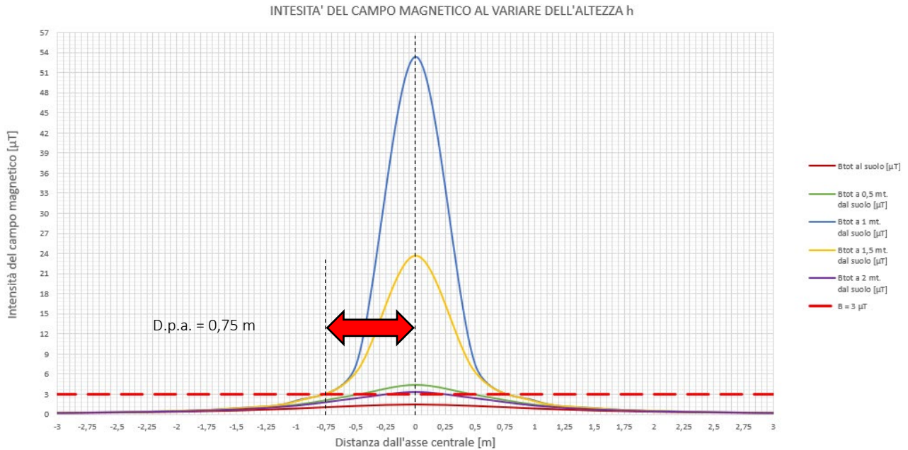
Figura 11: Diagramma dell'intensità dei campi elettromagnetici per la valutazione della DPA. – tratto S 6
