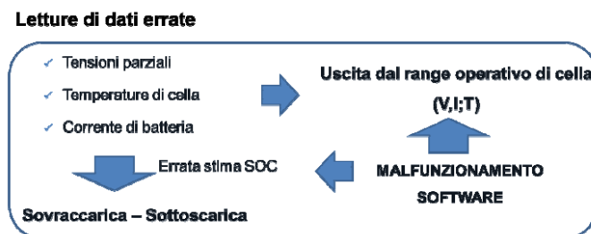
Figura 30: Conseguenze di una lettura errata delle grandezze cella
