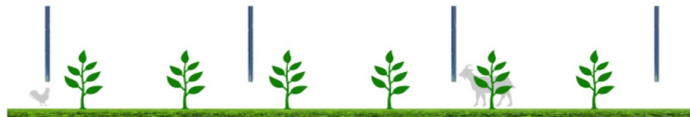
Figura 3: Sistema agrivoltaico in cui i moduli fotovoltaici sono disposti verticalmente. La coltivazione avviene tra le file dei moduli fotovoltaici, l'altezza minima dei moduli da terra influenza il possibile passaggio di animali (TIPO 3)
