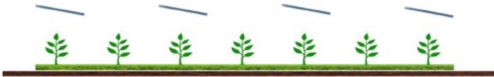
Figura 1: Sistema agrivoltaico in cui la coltivazione avviene tra le file dei moduli fotovoltaici, e sotto a essi (TIPO 1)
