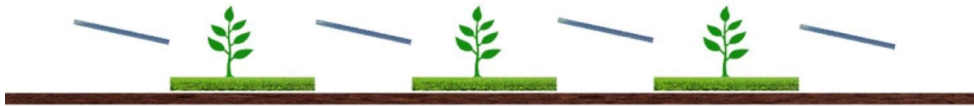
Figura 2: Sistema agrivoltaico in cui la coltivazione avviene tra le file dei moduli fotovoltaici, e non al di sotto di essi (TIPO 2)
