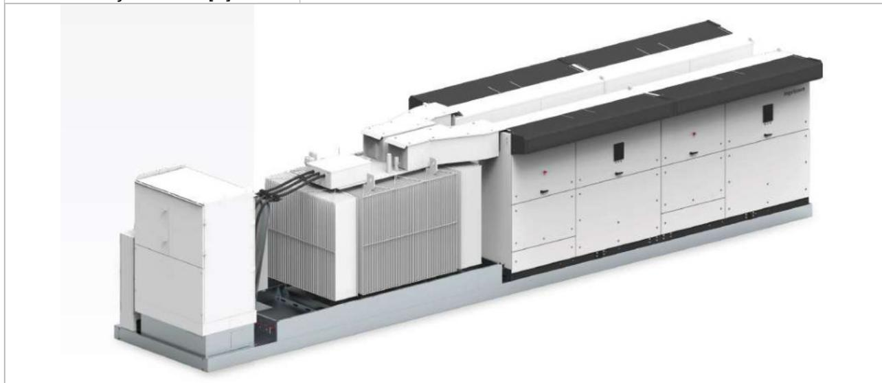
I componenti esterni sono montati su un telaio di base, realizzato in acciaio zincato a caldo. Tutti i componenti compresi gli inverter sono integrati sul telaio di base, completamente cablati e testati in fabbrica, mentre il trasformatore MT viene fornito preassemblato per una connessione veloce in loco.
