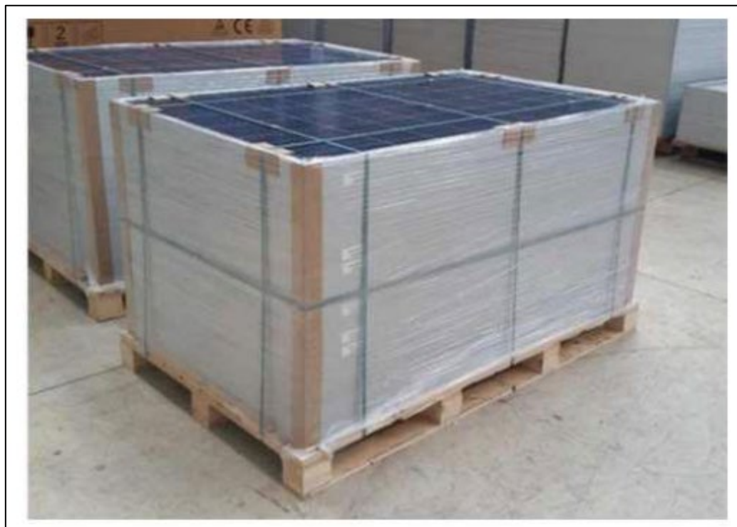
Figura 6: Impilamento e reggiatura dei pannelli fotovoltaici
