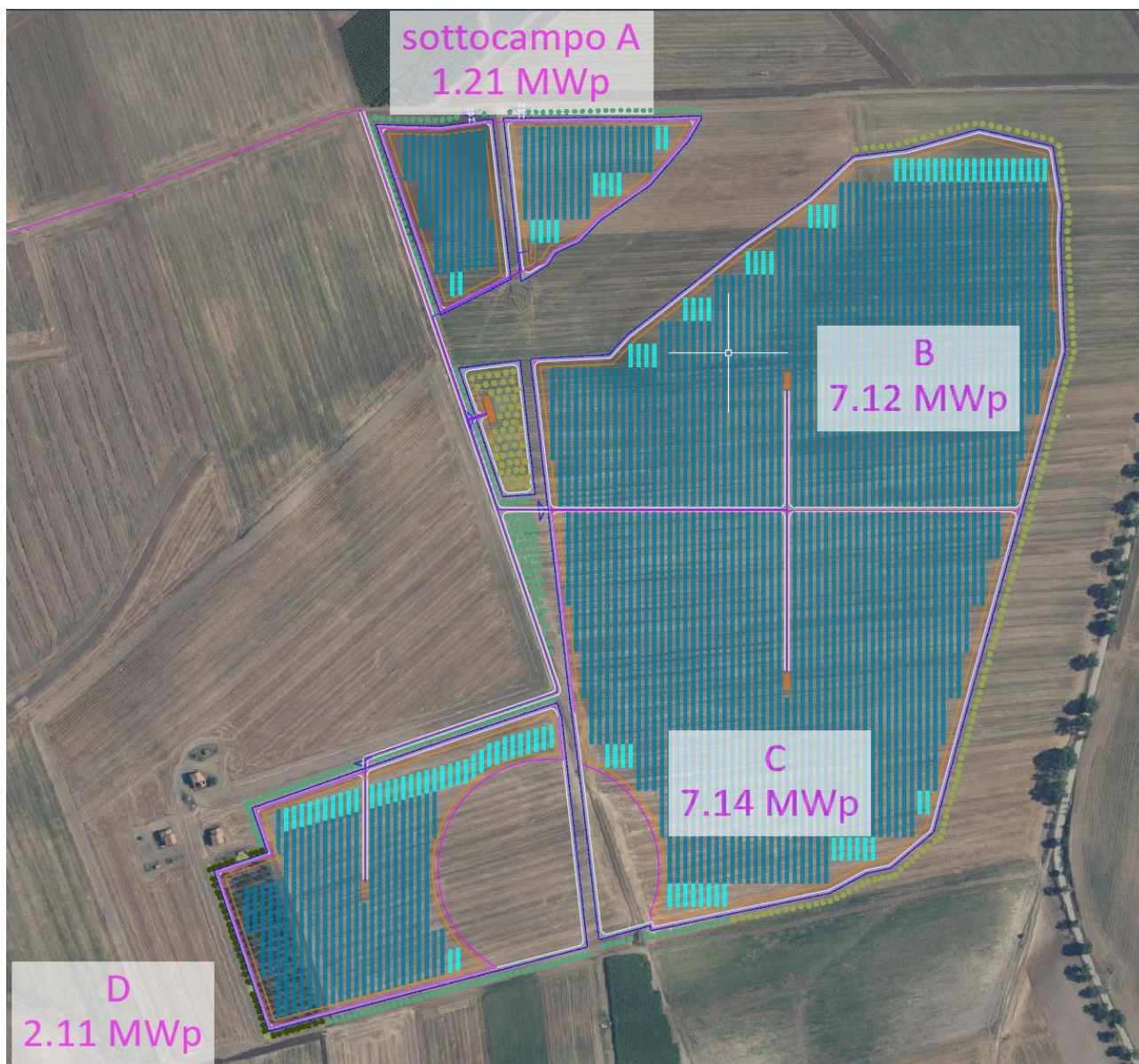
Figura 1 Suddivisione dell'impianto in sottocampi
