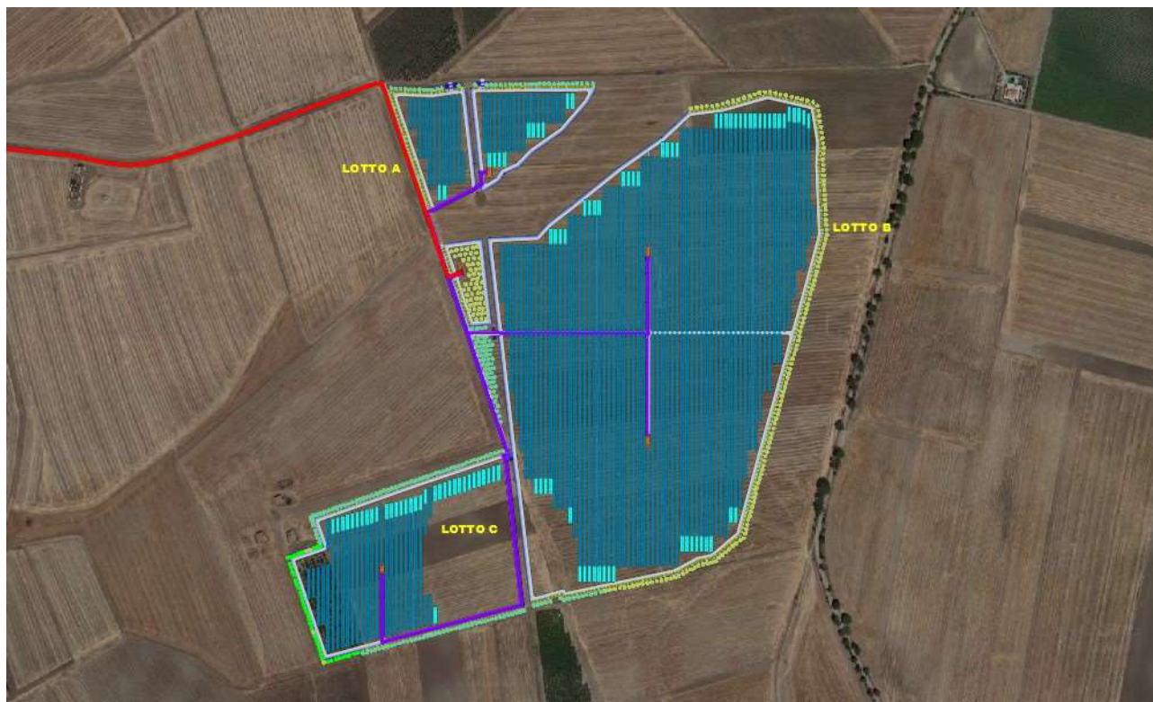
Figura 2. Layout dell'impianto Agro-fotovoltaico su ortofoto
