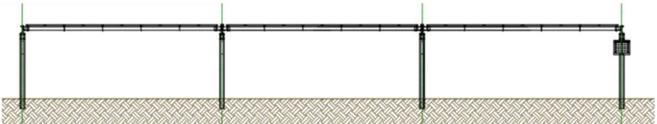
Figura 6. Tracker 1P - Vista Longitudinale in condizione di riposo
