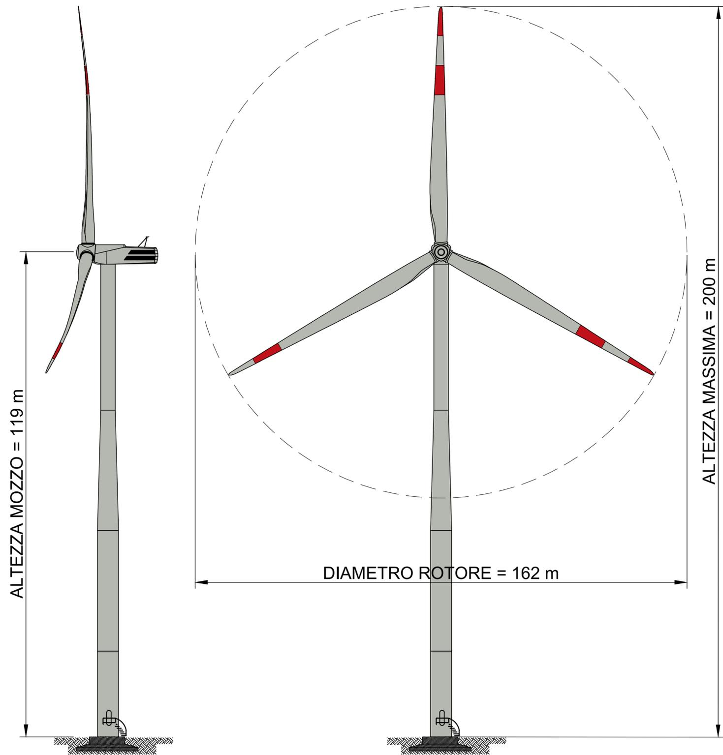
AEROGENERATORE MODELLO VESTAS - V162, ALTEZZA AL MOZZO 119 m E POTENZA UNITARIA 7,2 MW
