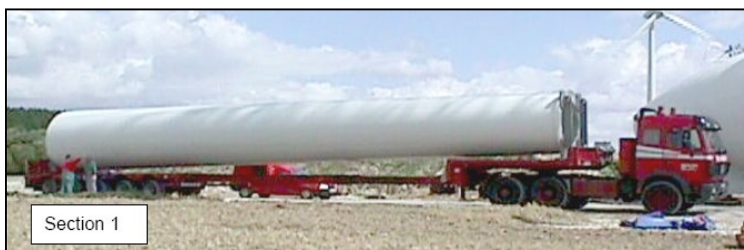
Figura 12: trasporto della sezione della torre
