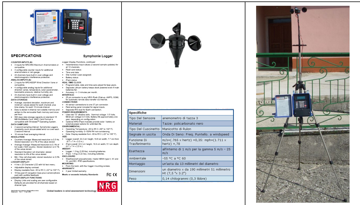
Figura 2 Stazione meteo portatile utilizzata- l'altezza di misura dei sensori è 1,5 m; Specifiche tecniche dell'NRG #40 Maximum caratteristiche tecniche DATA LOGGER
