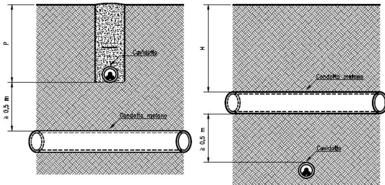
Fig. 12 - Attraversamenti di gasdotti - pressione gas compressa tra 0,5 e 5 bar
