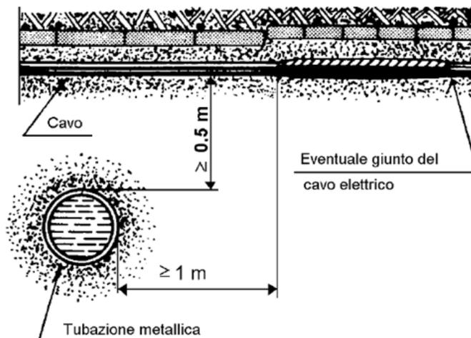
**Fig. 7 - Attraversamento tra percorso cavi di energia e tubazioni trasporto fluidi**
