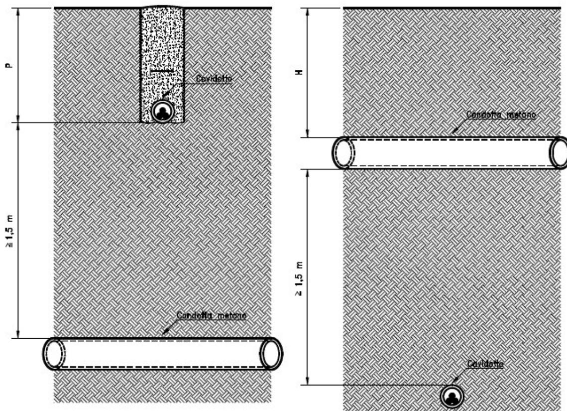
**Fig. 11 - Attraversamenti di gasdotti - pressione gas  $>5$  bar**
