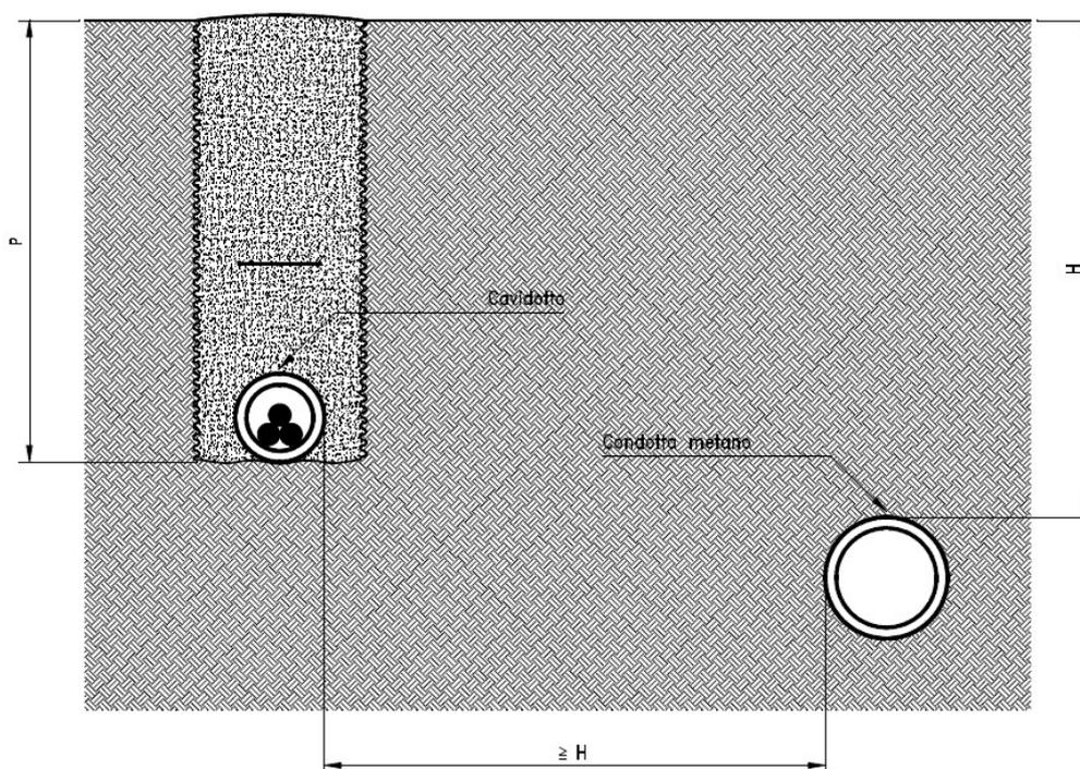
**Fig. 9 - Parallelismi con gasdotti - pressione gas >5 bar**
