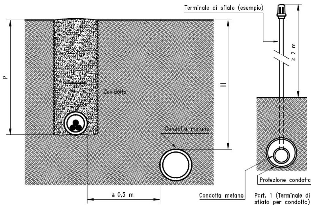
**Fig. 10 - Parallelismi con gasdotti - pressione gas  $< 5$  bar**
