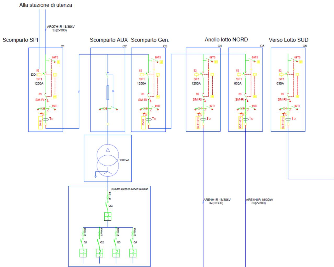
**Figura 9 - PARTICOLARE DI SCHEMA DELLA CABINA DI PARALLELO**
