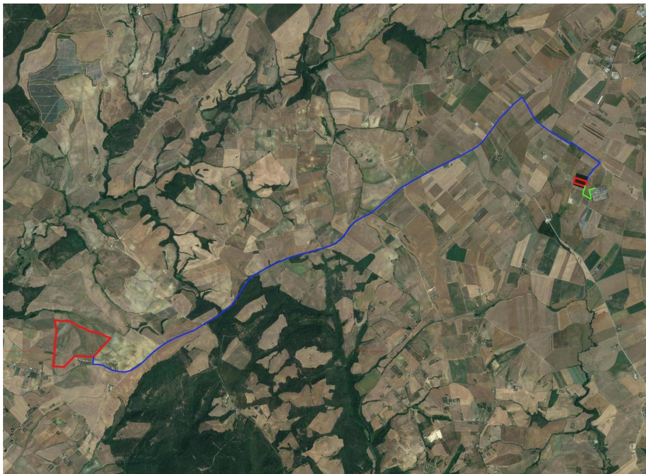
Figura 3 – Tracciato del cavidotto di connessione fino alla SE di Tuscania
