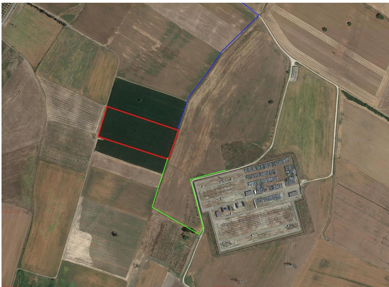
Figura 3 - Schematizzazione planimetrica del tracciato in cavo interrato AT
