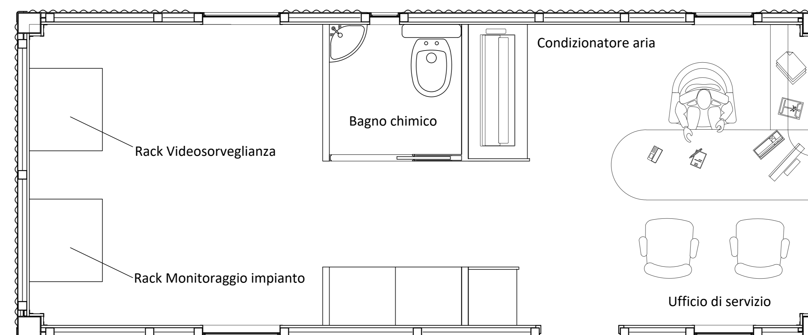
Control Room - Disposizione interna
