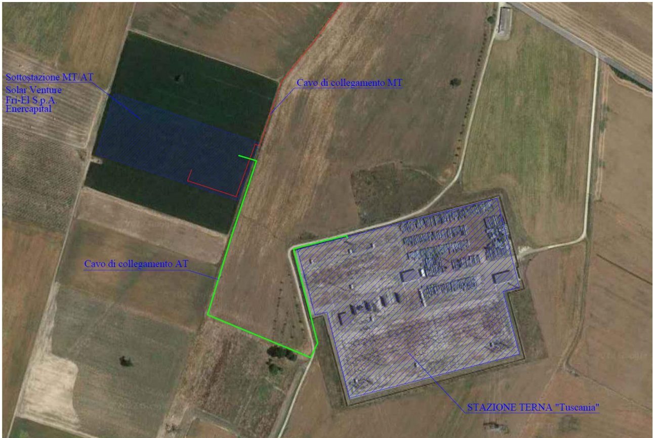
FIGURA 39 - Sottostazione di utenza su ortofoto
