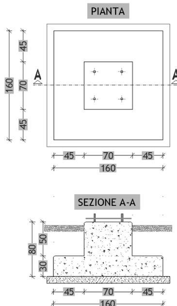
Fig. Pianta e sezione fondazione per trasformatore di tensione capacitivo
