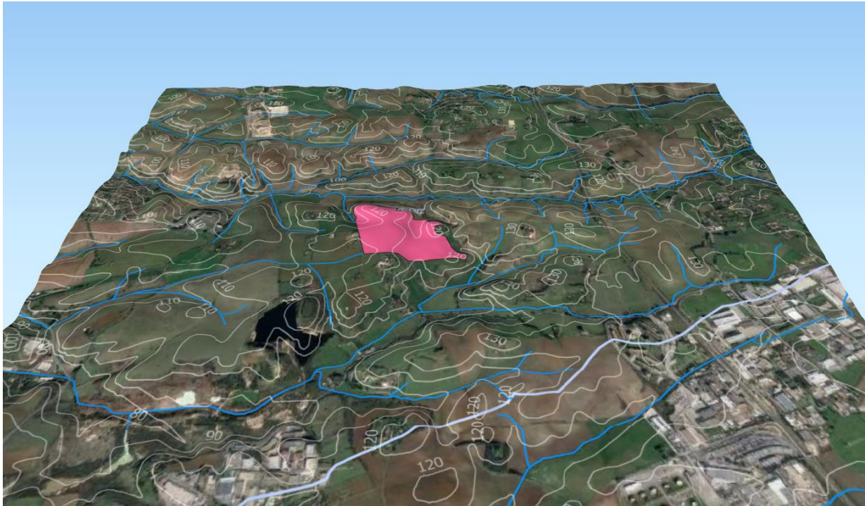
Figura 3-3: morfologia del territorio in esame con indicazione degli elementi idrici (in blu), isoipse (bianco) e aree di progetto; esagerazione verticale x2
