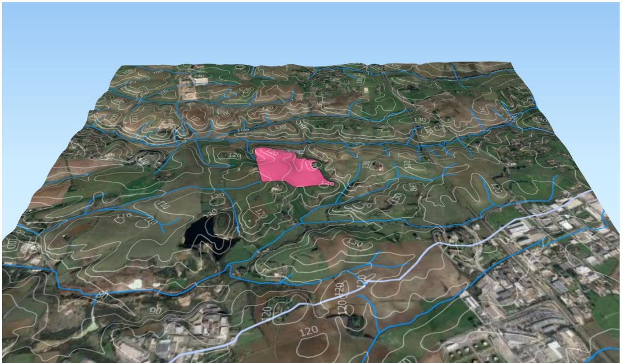
**Figura 4-1: morfologia del territorio in esame con indicazione degli elementi idrici (in blu), isoipse (bianco) e aree di progetto; esagerazione verticale x2**
