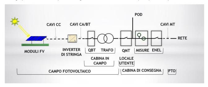
L'impianto FV ha la capacità di generare energia elettrica dai Moduli FV: ogni singolo Modulo FV trasforma l'irraggiamento solare in energia elettrica, generata in forma di corrente continua.
