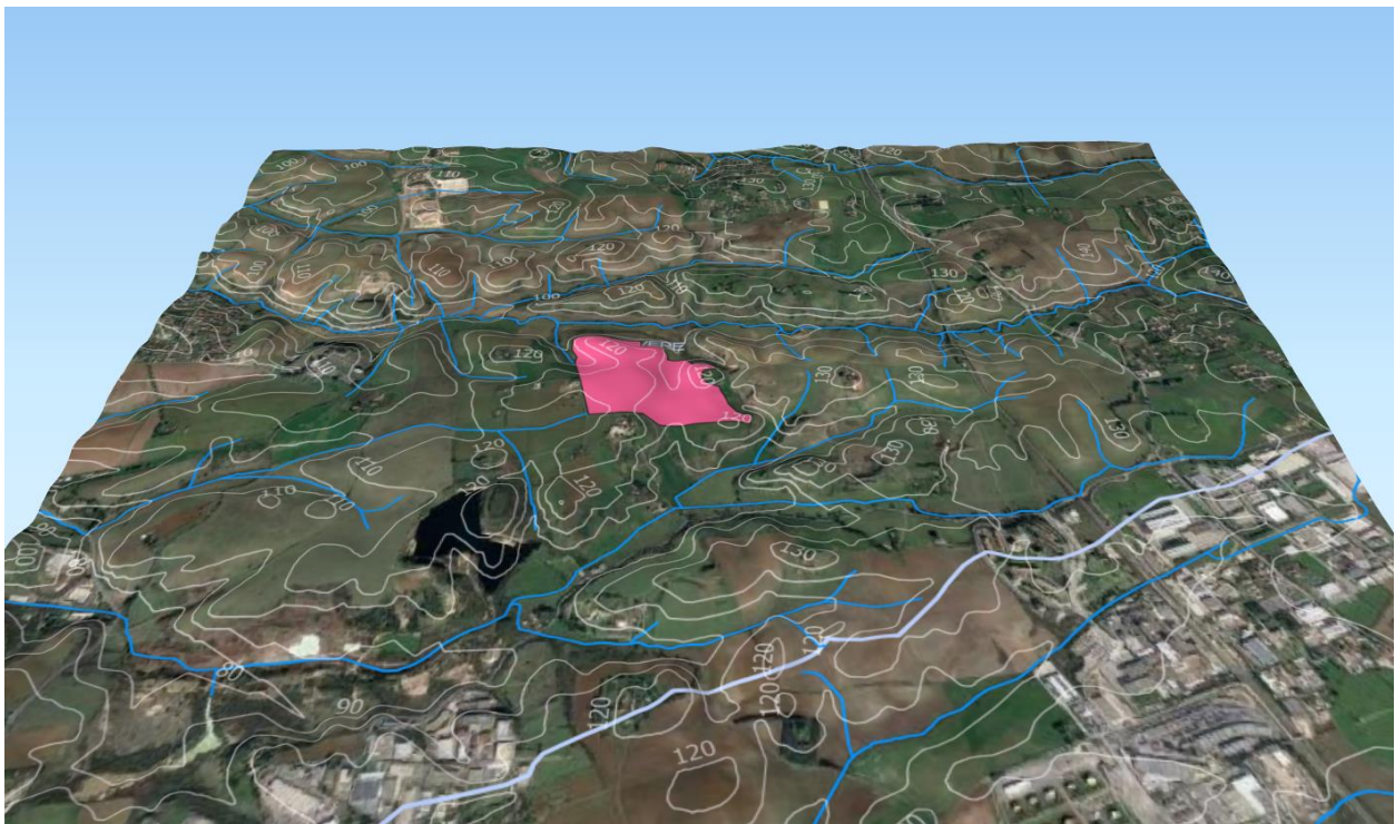
Figura 4-9 morfologia del territorio in esame con indicazione degli elementi idrici (in blu), isoipse (bianco) e aree di progetto; esagerazione verticale x2
