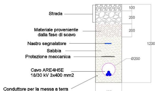
TIPICO CAVIDOTTO M.T. INTERRATI POSA INTERRATA IN PIANO SU SEDE STRADALE
