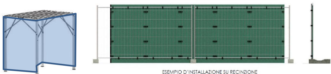
Figure 30 – Esempio area destinata al taglio elementi lapidei chiusa con pannelli fonoisolanti / fonoassorbenti e di barriera acustica con le caratteristiche richieste: tipo "Rapida F4" CIR Ambiente
