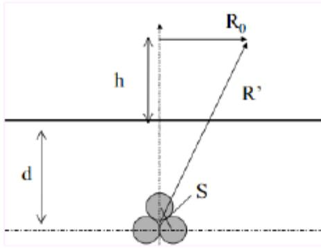
**Figura 12 – Schema di principio per il calcolo delle distanze da terne di cavi interrati con posa a trifoglio oltre le quali l'induzione magnetica è inferiore all'obiettivo di qualità (d è la profondità del centro del conduttore)**
