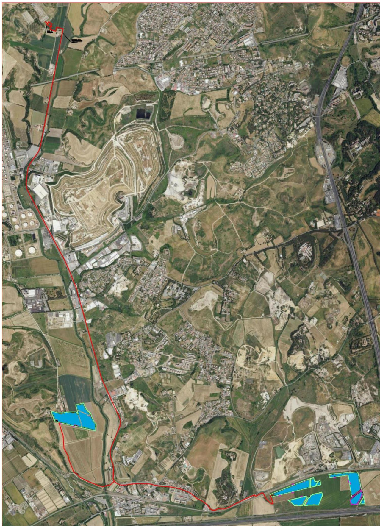
Fig. 2-3 : Individuazione su immagine satellitare. Aerea impianto fotovoltaico, cavidotto e SE di connessione
