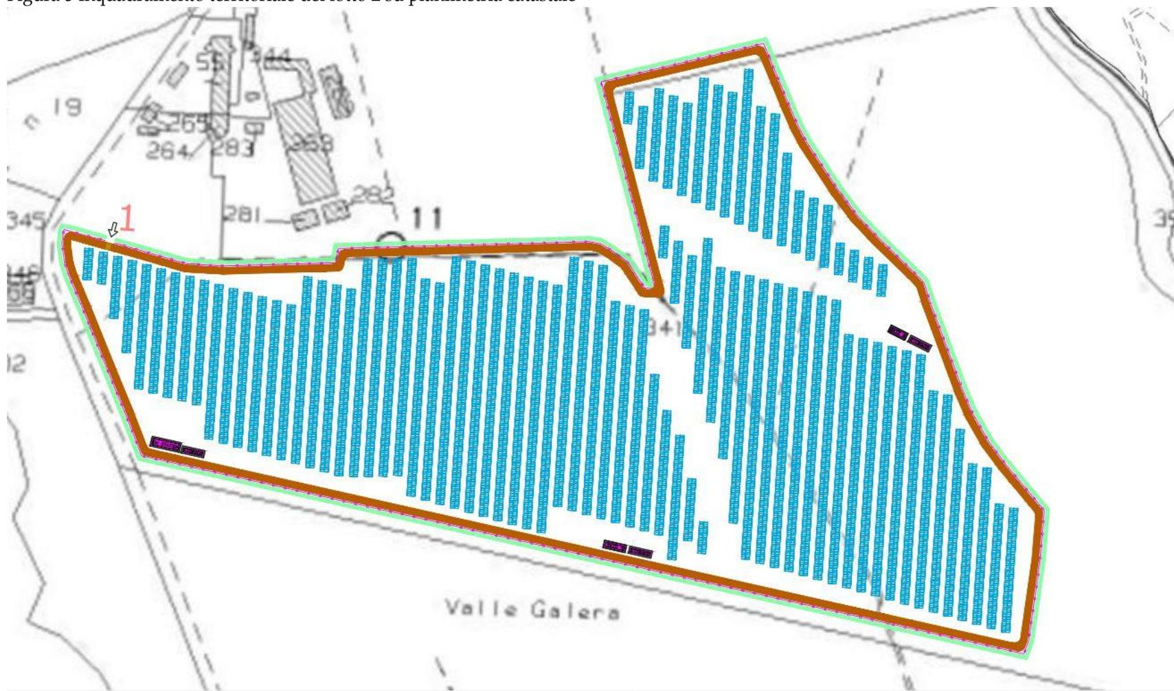
Figura 6 rappresentazione grafica collocazione delle strutture e dei pannelli FTV
