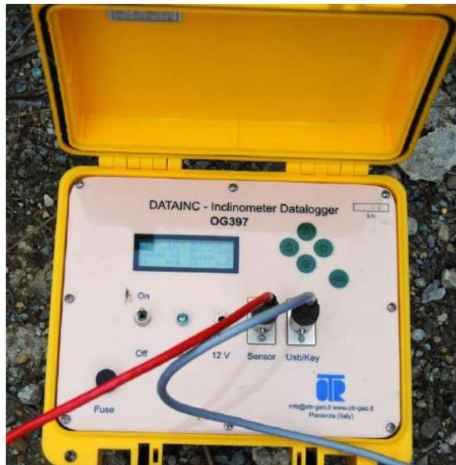
Mediante cavetto USB i dati acquisiti sono inviati ad un notebook dove è installato il software OG390WIN della O.T.R. s.r.l. che permette di controllare il funzionamento dell'apparecchiatura e di acquisire e memorizzare su file i valori rilevati dai due sensori inclinometrici durante la misura.
