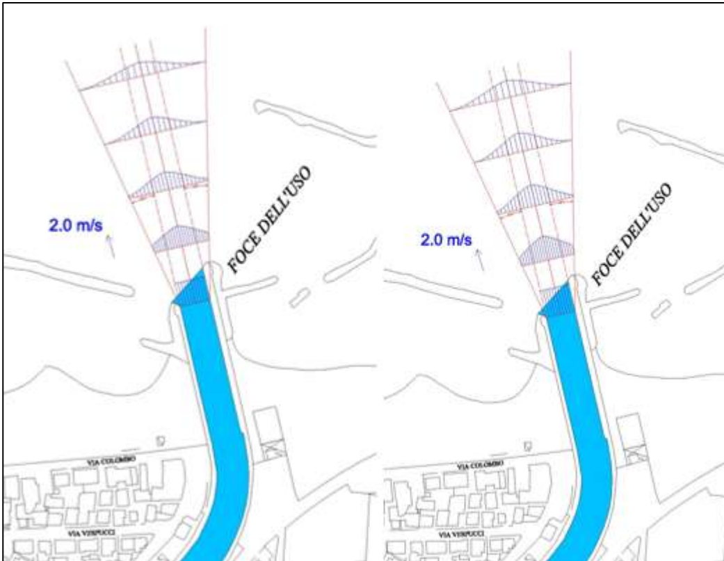
Figura 2.4-6: Espansione del getto fluviale con piena Tr 30anni (sinistra) e 200 anni (destra).
