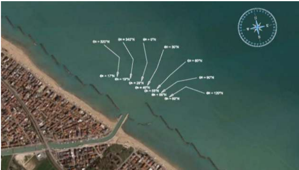
Figura 4.1-7: Rotazione dei fronti d'onda dal largo alla batimetrica -4.0m – onde con Tr 30anni
