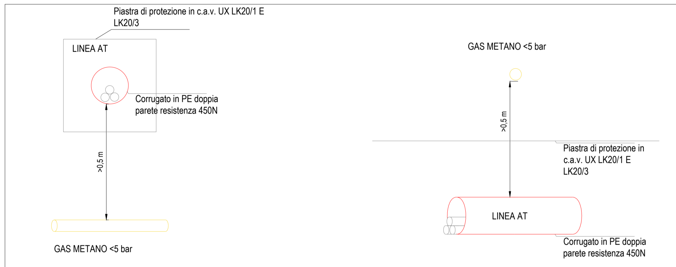
Posizionamento del cavidotto MT rispetto ad incrocio con sottoservizi esistenti - metanodotto >5 bar
