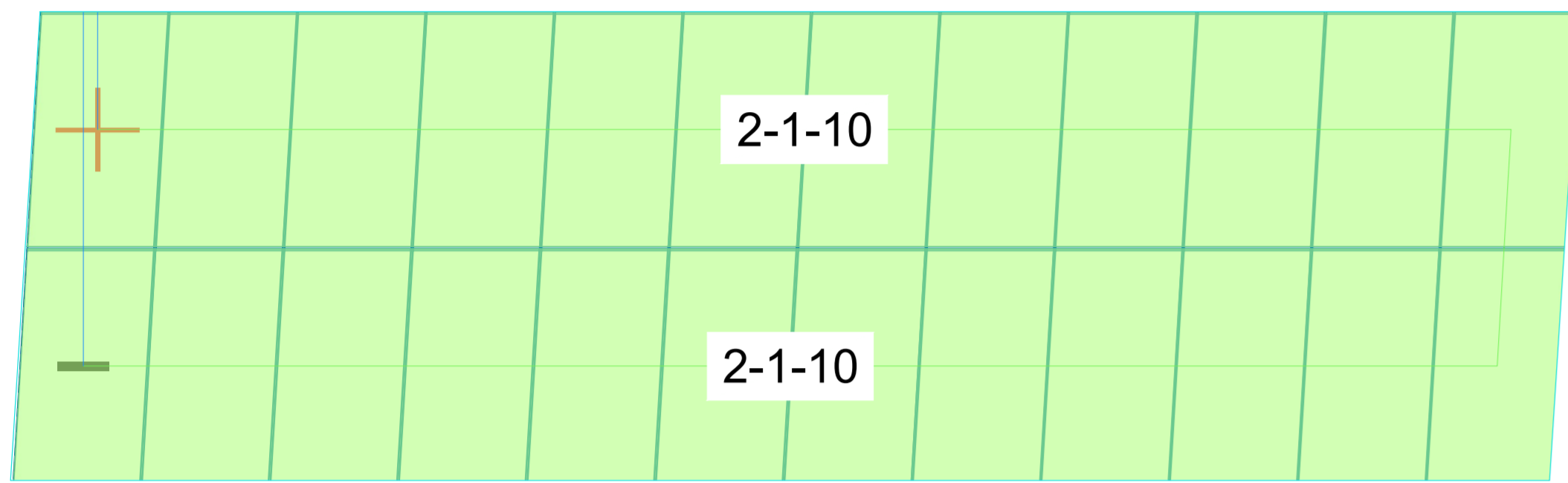
Particolare collegamento stringa - stringbox AREA PS2 (Esempio PS2 - String box numero 1 - stringa numero 10) Scala 1:50
