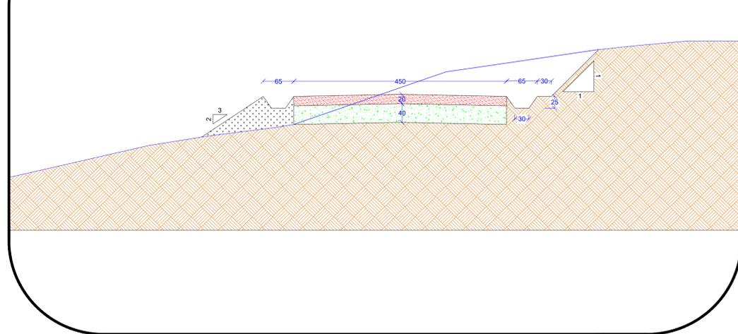
SEZIONE TIPO - STRADA IN RILEVATO
