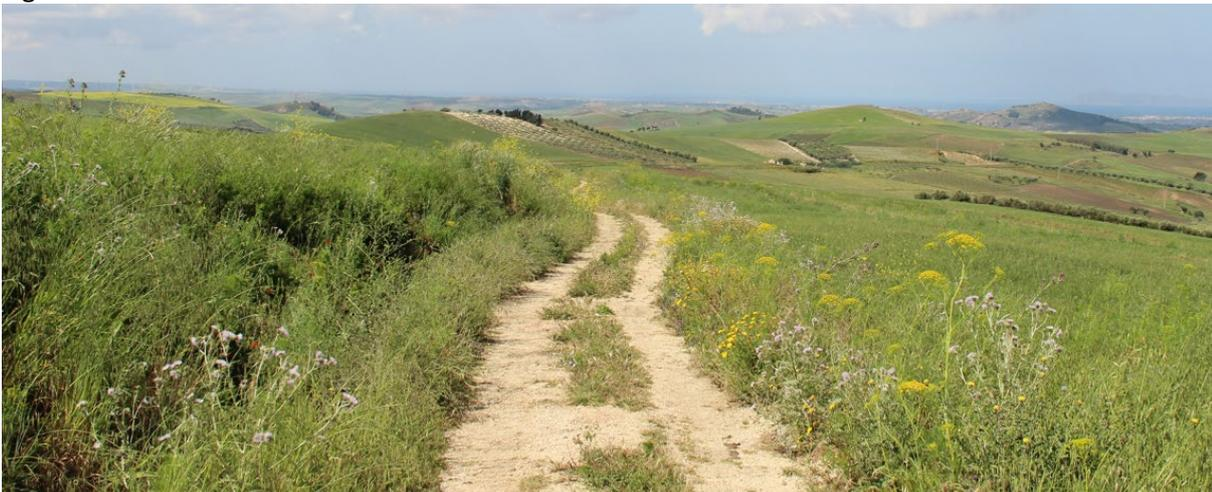
Figura 22 – strada vicinale “Racarrume” nel tratto in avvicinamento alla torre A09 – tale strada verrà in parte adeguata e sarà interessata dalla posa del cavidotto interno e verrà utilizzata per aggiungere anche la posizione della torre A08
