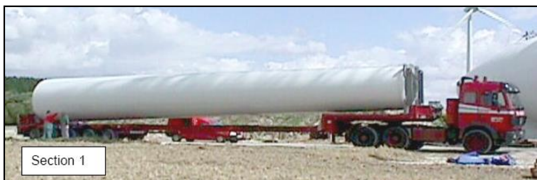
Figura 12: trasporto della sezione della torre
