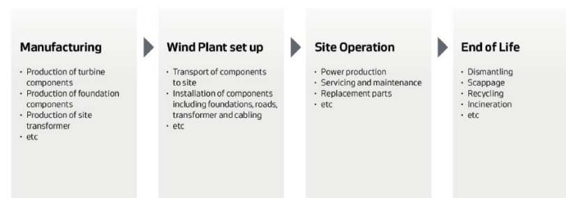
Figura 7 – Fasi del ciclo di vita di un impianto eolico
