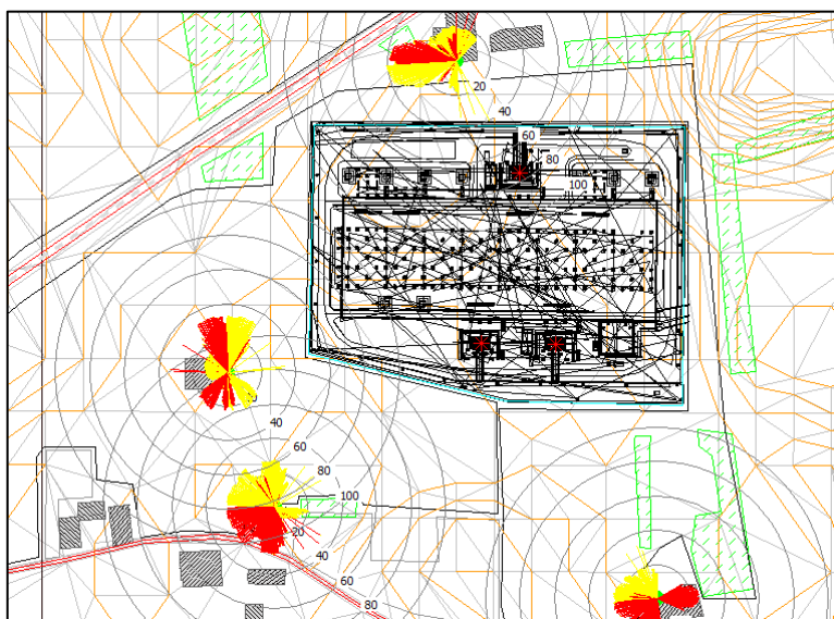
Figura 4: Specifica dell'applicazione della tecnica di calcolo a tracciamento di raggi (ray-tracing).
