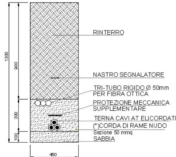
Fig. 4: Sezione C-C: di posa 1 terna su terreni
