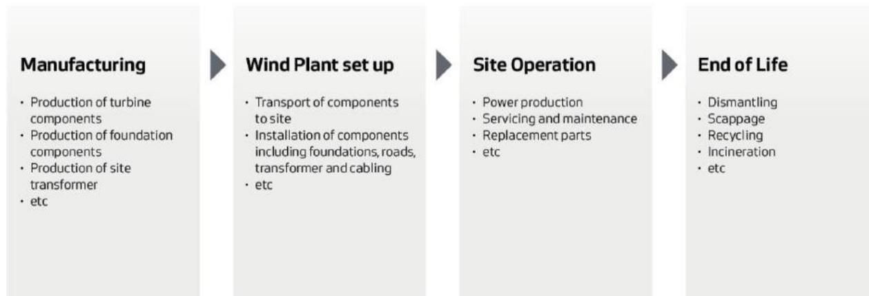
**Figura 2 – Fasi del ciclo di vita di un impianto eolico**
