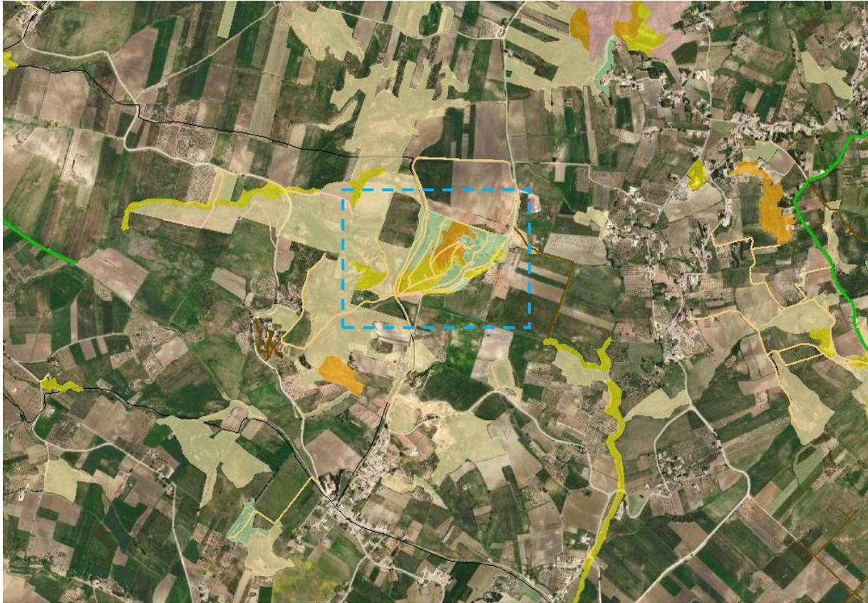
**Figura 4** – presenza di piste forestali sull’area d’influenza del parco eolico in corrispondenza dell’area con modello combustibile mod.9. In verde sono indicate piste forestali di tipo camionabile secondarie, in marrone le piste forestali di tipo carrareccia, in ocra le piste trattorabili – nel rettangolo azzurro è evidenziato il soprassuolo con modello combustibile appartenente al modello 9 ricadente nell’area d’influenza del parco.
