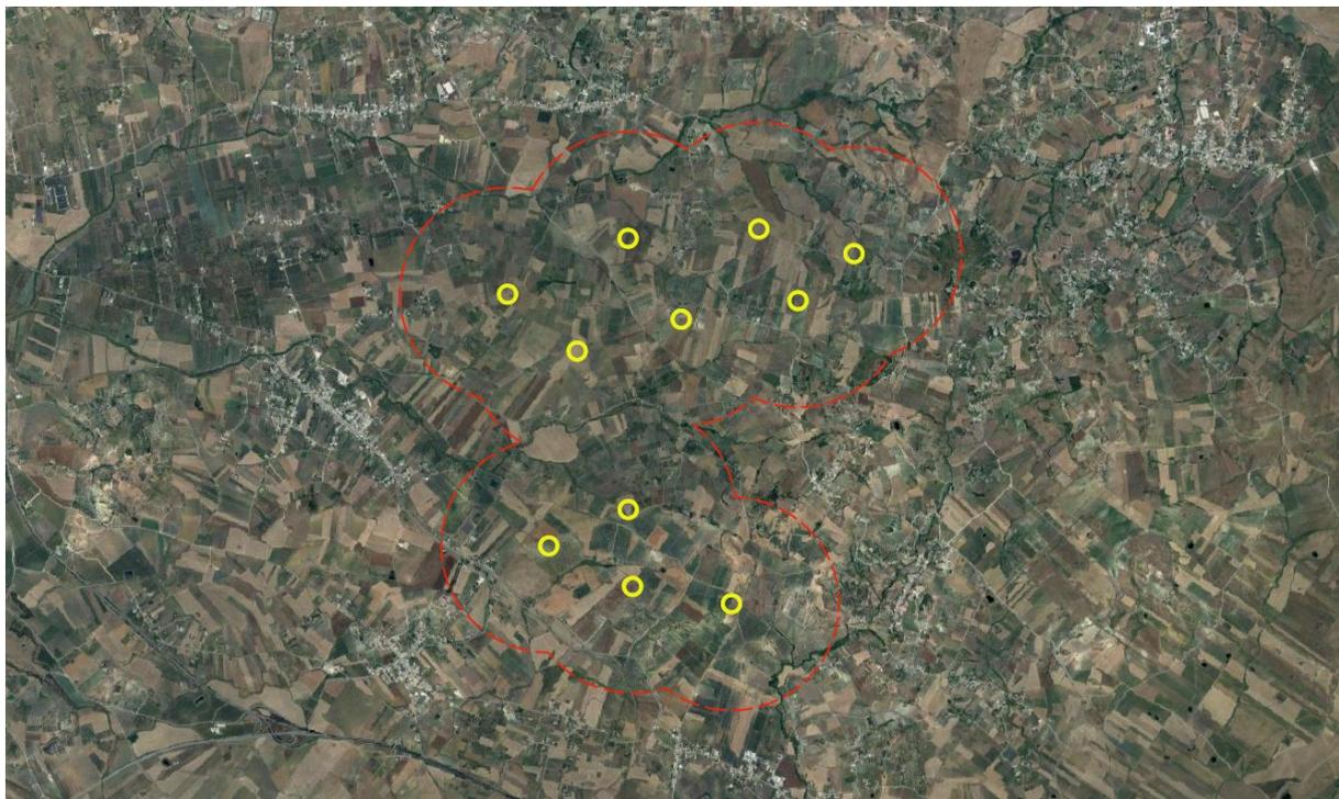
**Figura 1** – inquadramento su fotopiano degli aerogeneratori di progetto (in blu) e dell'area d'influenza del parco (in rosso) pari al raggio di 1 km da ogni aerogeneratore.
