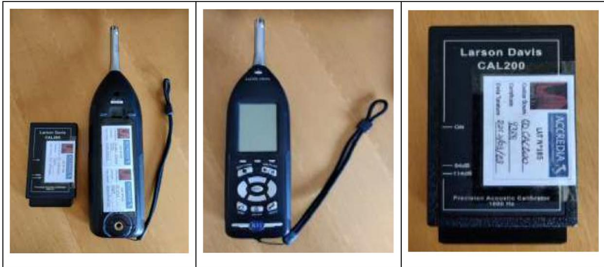
**Figura 1: strumentazione fonometrica che si prevede di utilizzare**
