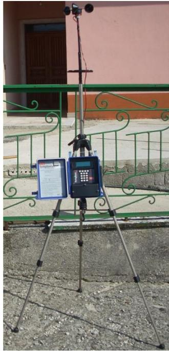
**Figura 2: Stazione meteo portatile utilizzata - l'altezza di misura dei sensori è 1,5 m; Specifiche tecniche dell'NRG #40 Maximum caratteristiche tecniche DATA LOGGER**
