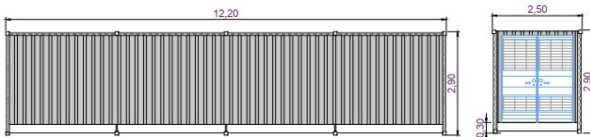
Figura 7-10 – Layout tipico Modulo batterie
