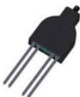
Il sensore opera con un principio di misura a 4 elettrodi, che garantisce accuratezza e stabilità nel tempo della misura. Può essere impiegato per valutare la conducibilità elettrica di un campione di terreno, consentendo così di valutare la concentrazione di ioni disciolti, ottimizzando l'apporto di fertilizzante disciolto nell'acqua di irrigazione.
