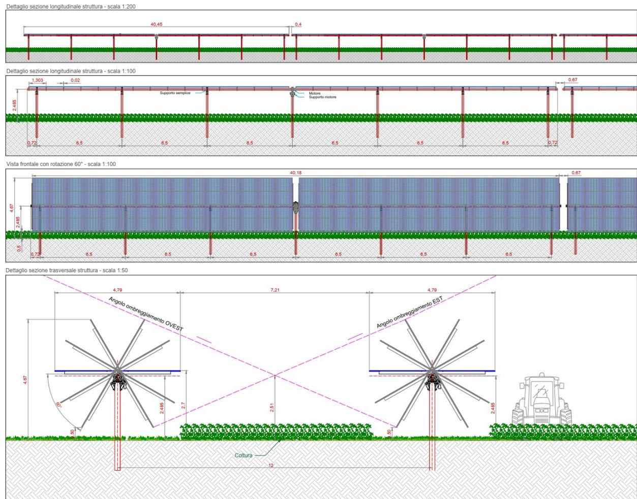
Figura 7-3 – Sezione trasversale tipologica struttura Tracker
