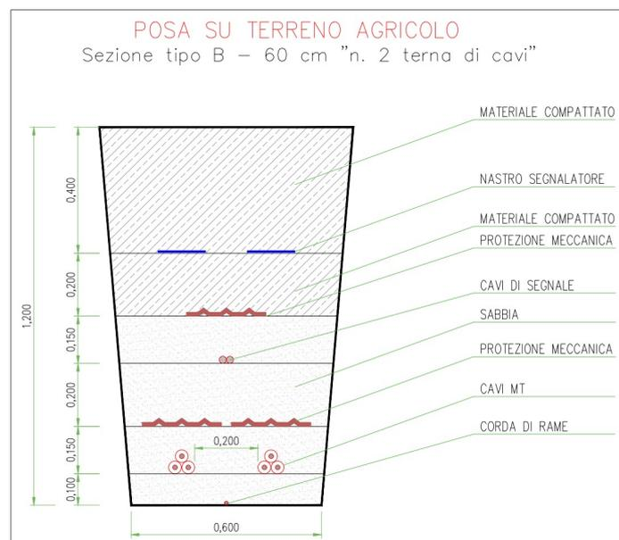
Figura 8-5 – Sezione tipica posa cavi MT
