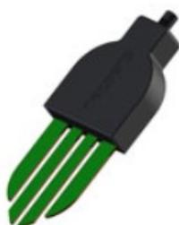
Il sensore determina la percentuale di acqua presente nel terreno circostante, attraverso la misura della costante dielettrica relativa.
