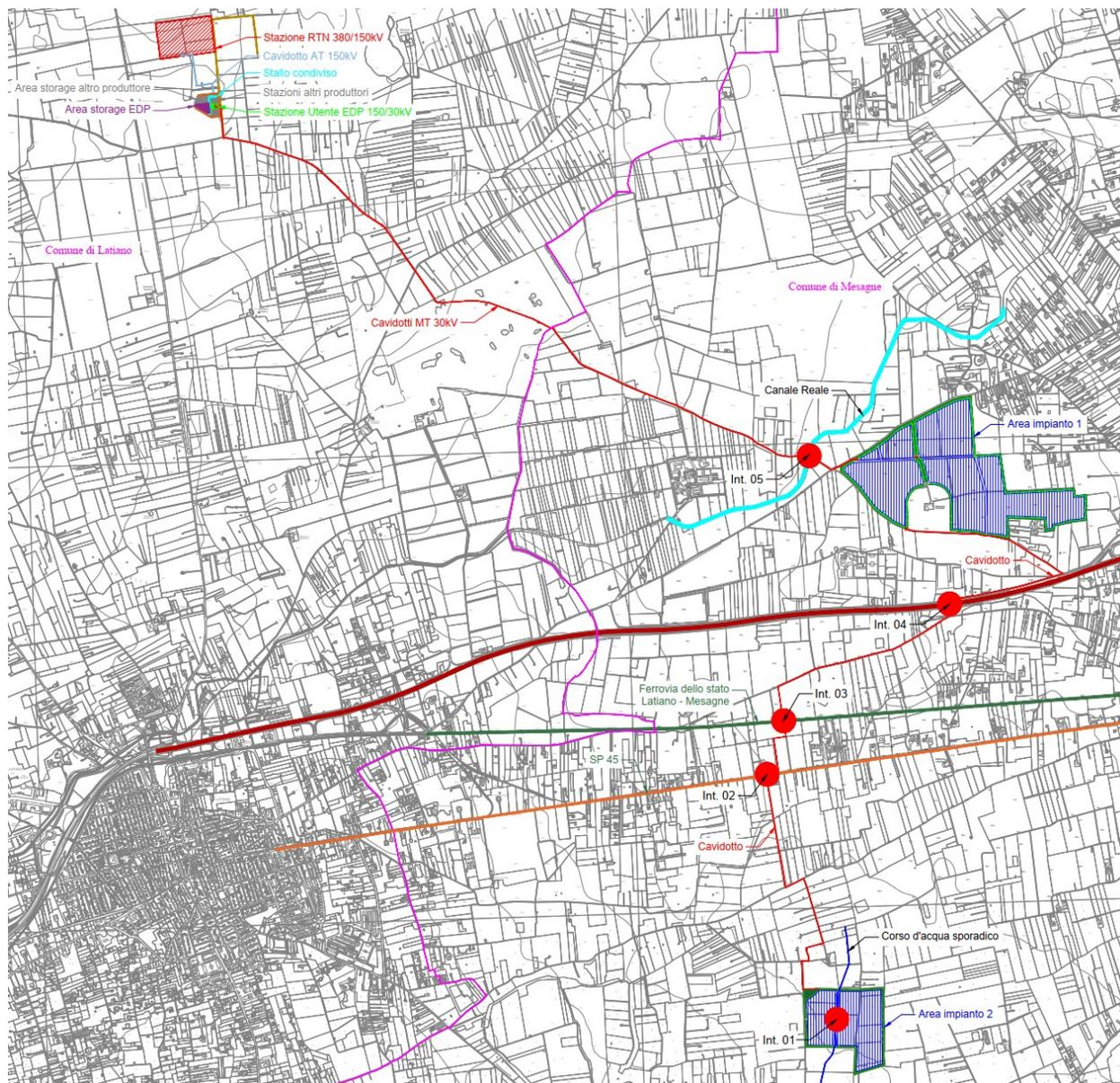
Figura 9-1 – Identificazione interferenze cavi MT su CTR
