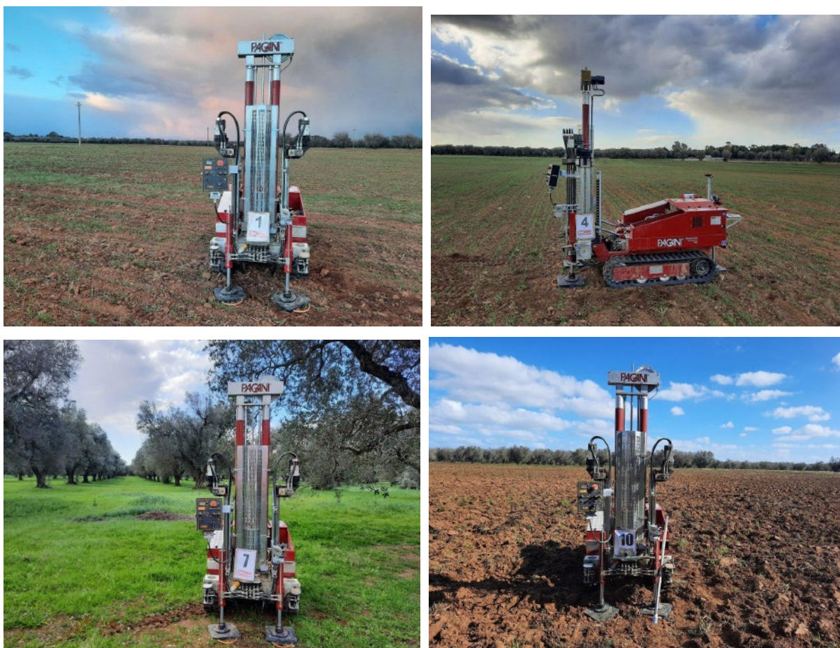
Figura 7-3 – Fasi di esecuzione prove penetrometriche DPSH
