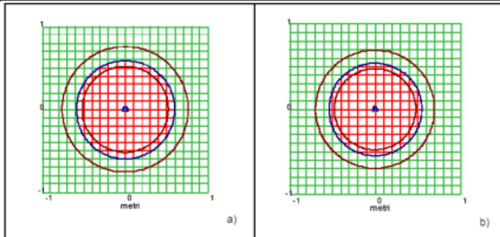
Curve isolivello dell'induzione magnetica per cavi cordati ad elica MT
