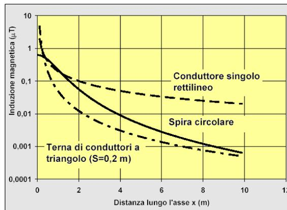
In riferimento alla intensità del campo prodotto dalle linee in cavo si sono utilizzate le relazioni qui illustrate e contenute nella guida CEI 106-12 2006-05 "Guida pratica ai metodi e criteri di riduzione dei campi magnetici prodotti dalle cabine elettriche MT/BT.
