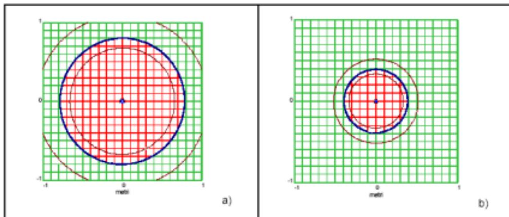
Curve isolivello dell'induzione magnetica per cavi cordati ad elica BT
