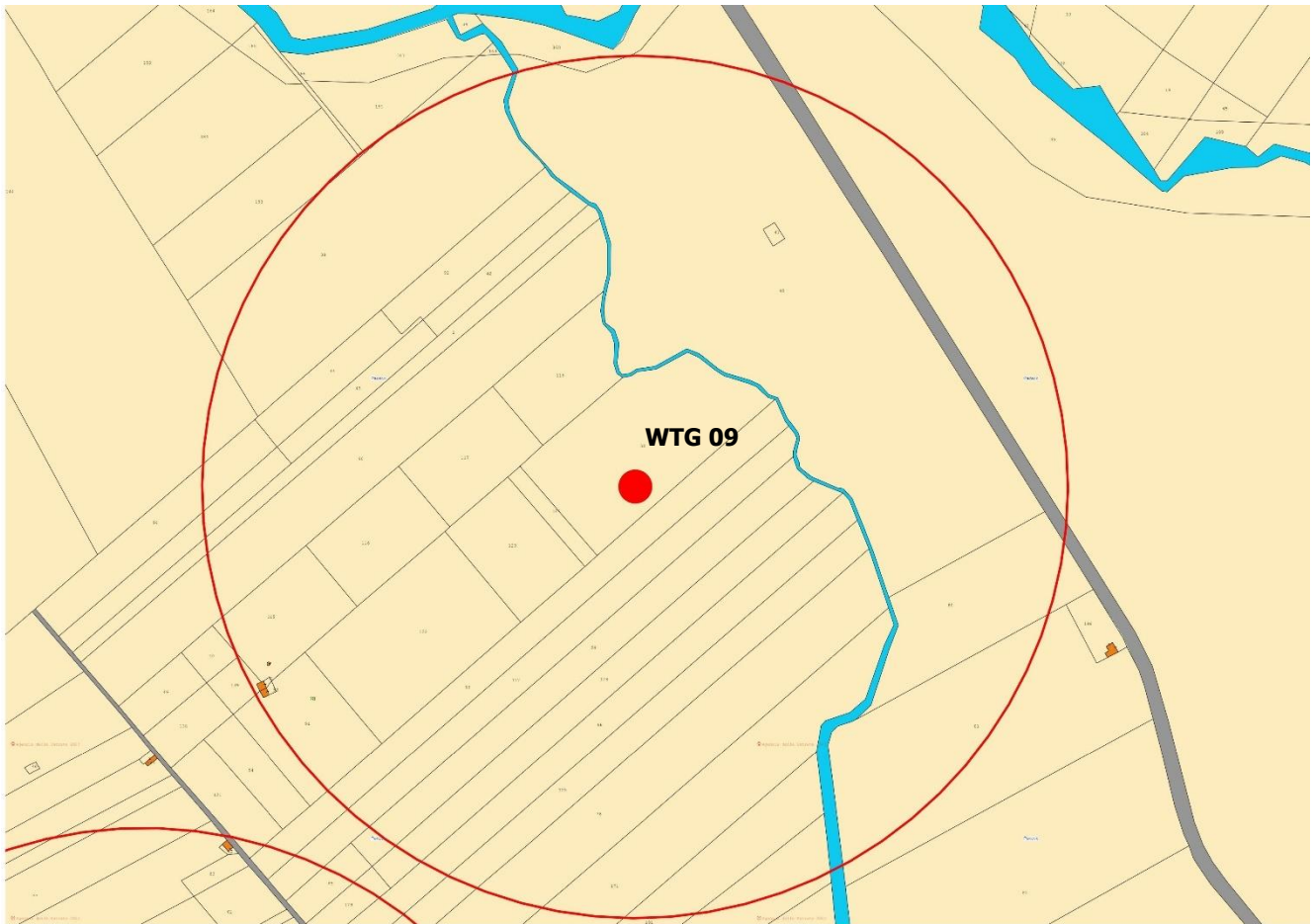
Figura 11–Indicazione della gittata massima della pala in caso di distacco su Catastale (ID 13-14)
