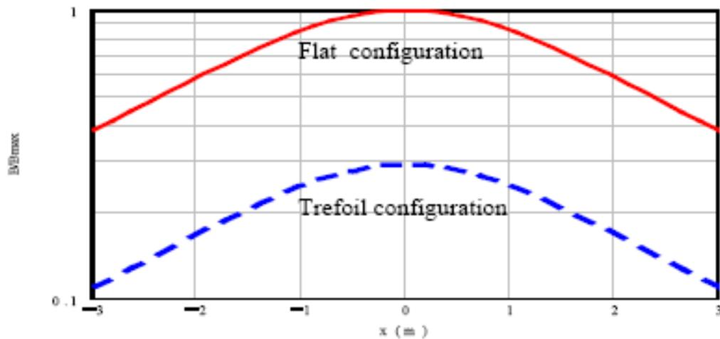
Figura 6-3: Attenuazione dell'induzione magnetica dovuta all'utilizzo di cavidotti con cavi in configurazione planare o trifase
