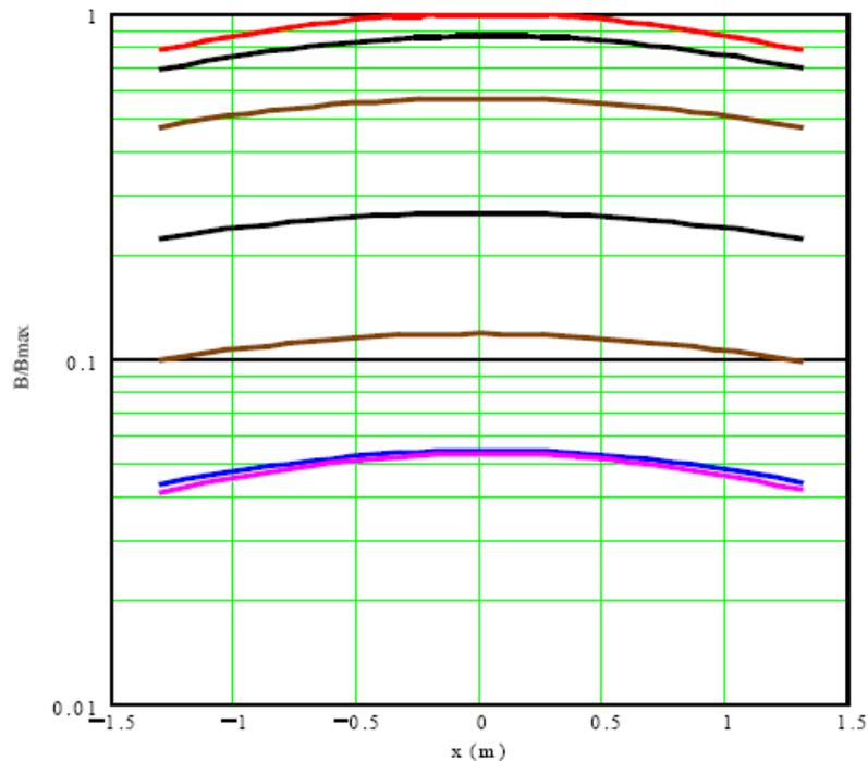
**Figura 6-4: Attenuazione dell'induzione magnetica con la distanza per effetto della schermatura**
