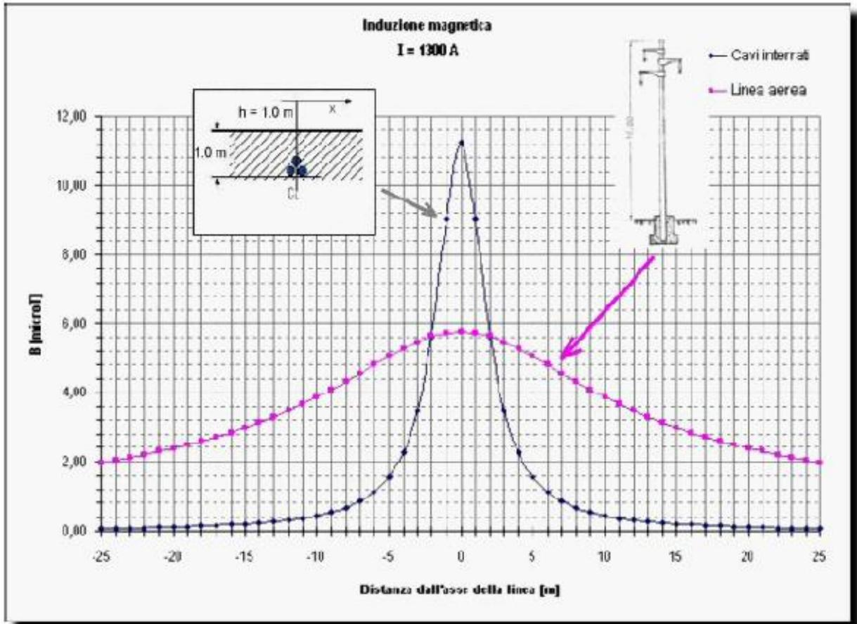
Figura 6-2: Attenuazione dell'induzione magnetica dovuta all'interramento dei cavi
