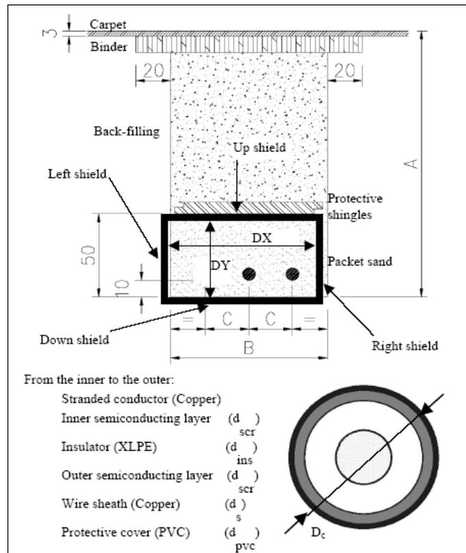
**Figura 6-1: Rappresentazione schematica di un cavidotto interrato: caratteristiche geometriche, configurazione, schermatura**
