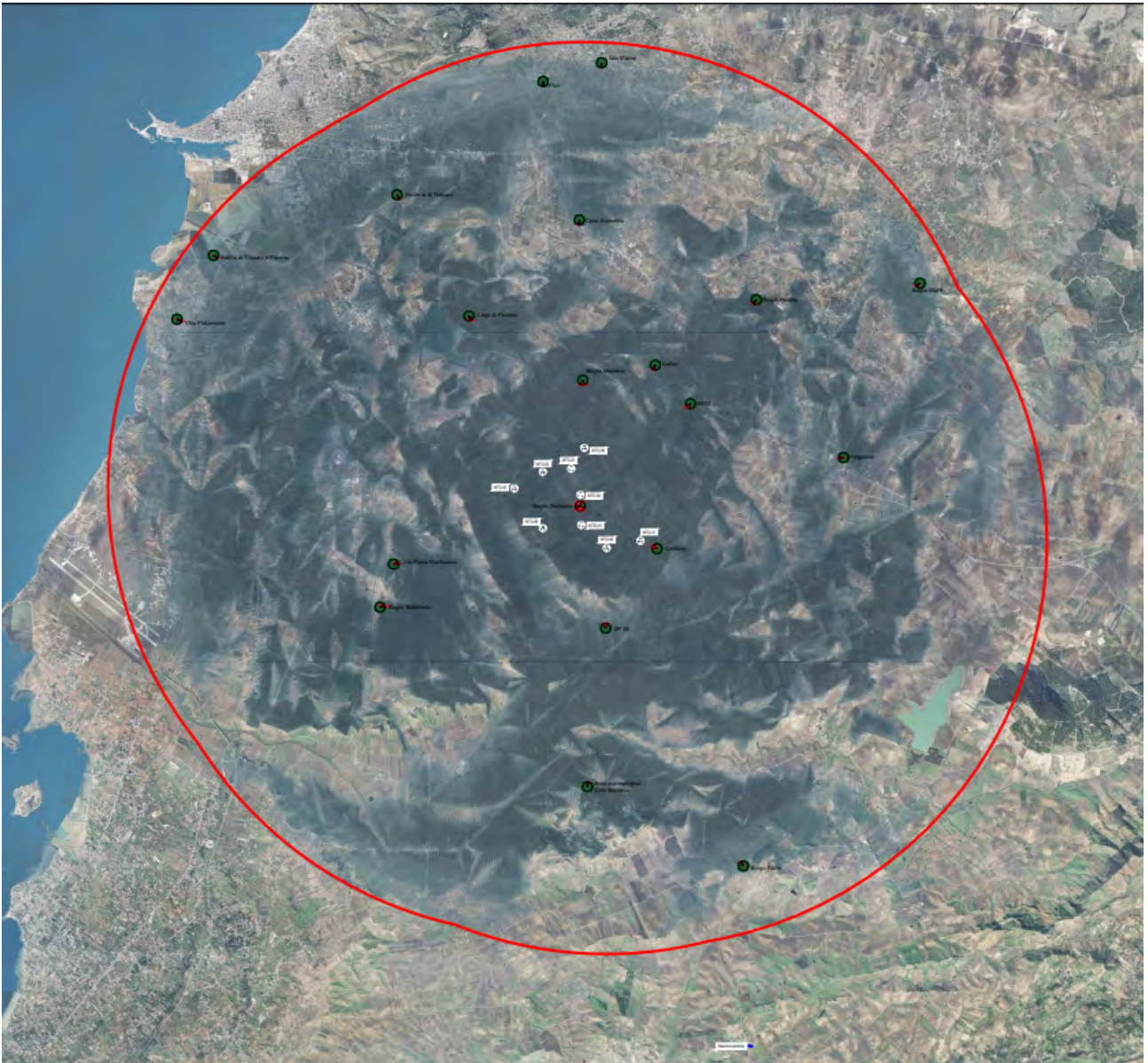
Fig. 15 - Mappatura delle zone bersaglio con ZVI per numero di aerogeneratori visibili e campi visuali interferenziali
