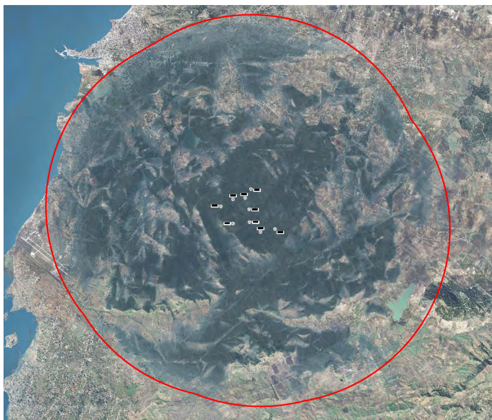
Fig. 04 - ZVI teoriche dell'impianto differenziate per numero di aerogeneratori visibili. Nelle aree centrali dell'area vasta, il numero di aerogeneratori è pari al totale di progetto in pressoché tutti i punti di osservazione.
