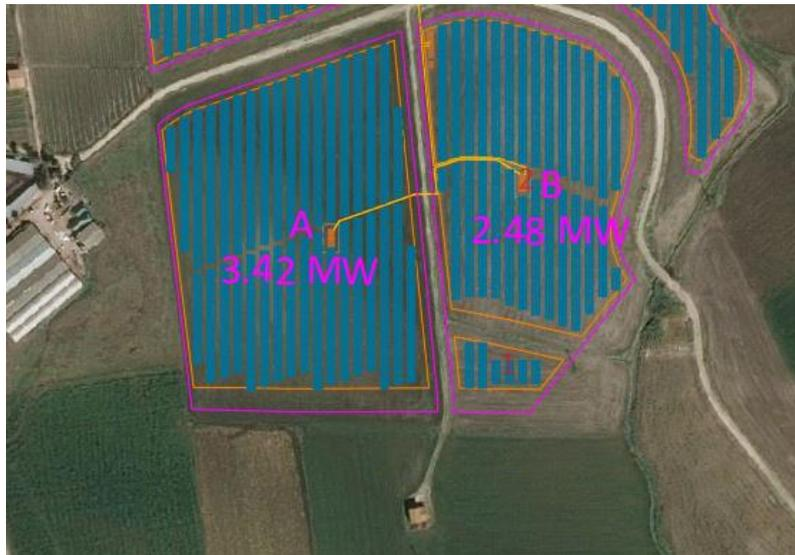
*Figura 12 - Collegamento entra-esce PS Sottocampo A e Sottocampo B*
