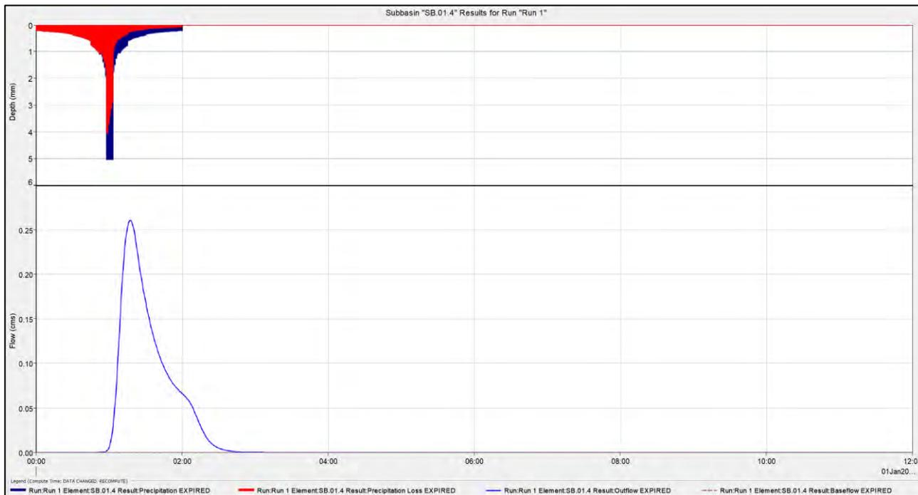
**Figura 17: letogramma di progetto e relativo idrogramma di piena del sotto-bacino SB.01.4**
