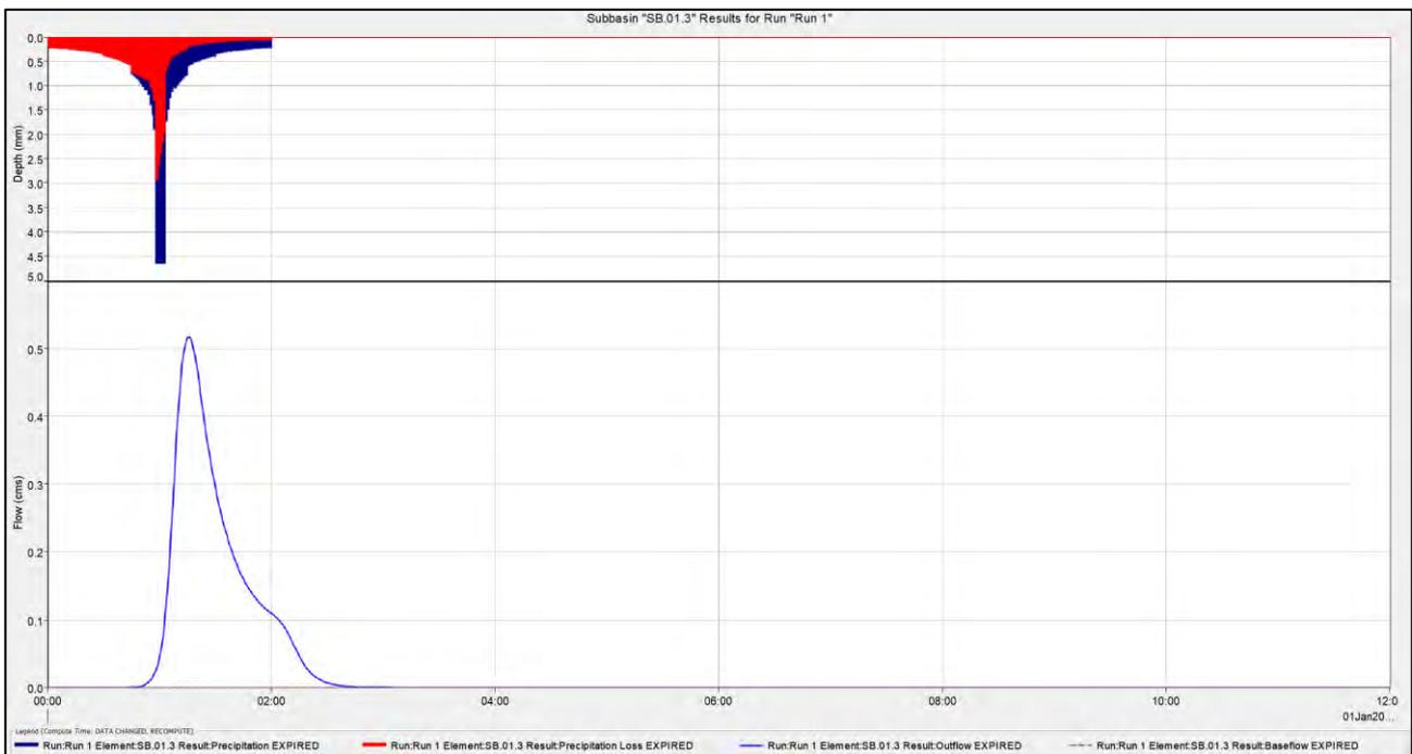
**Figura 16: letogramma di progetto e relativo idrogramma di piena del relativo sotto-bacino SB.01.3**
