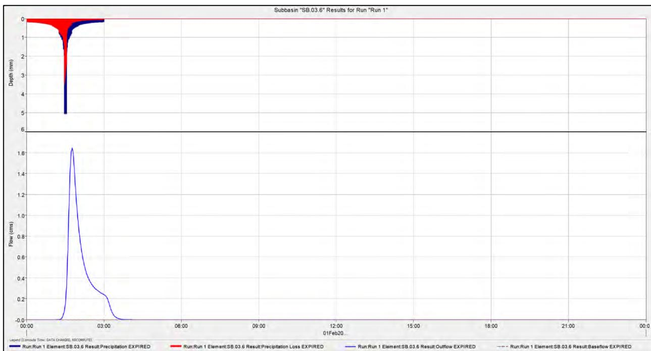
**Figura 33: letogramma di progetto e relativo idrogramma di piena del relativo sotto-bacino SB.03.6**
