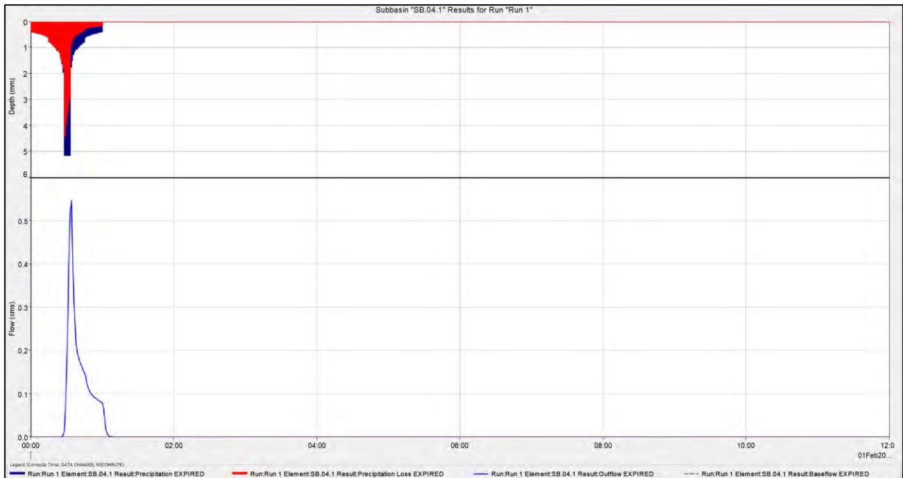
**Figura 50: letogramma di progetto e relativo idrogramma di piena del relativo sotto-bacino SB.04.1**
