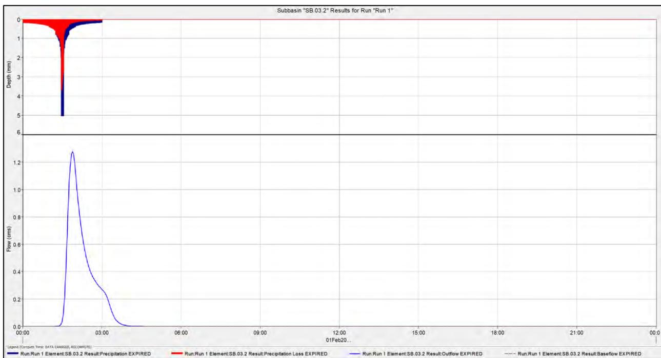
**Figura 29: letogramma di progetto e relativo idrogramma di piena del relativo sotto-bacino SB.03.2**
