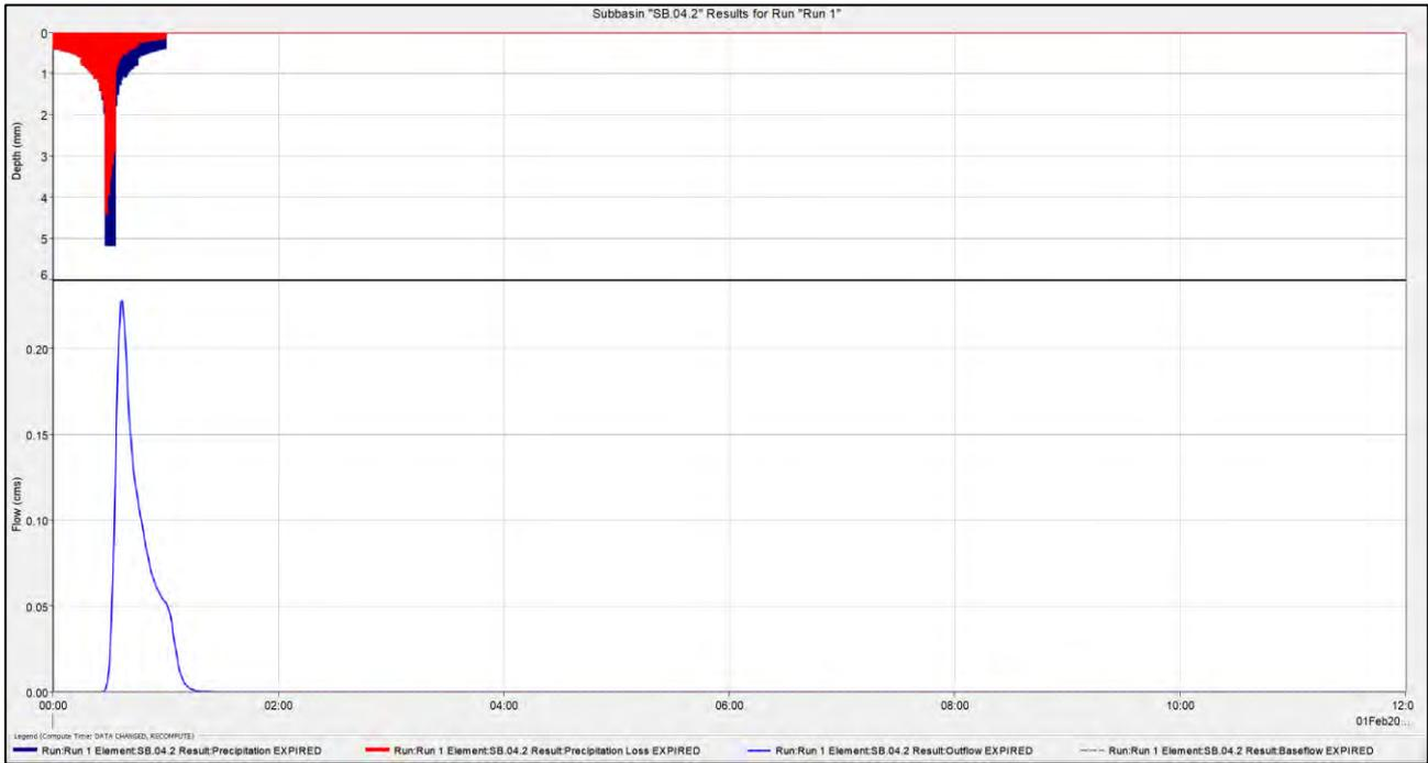
**Figura 51: letogramma di progetto e relativo idrogramma di piena del relativo sotto-bacino SB.04.2**
