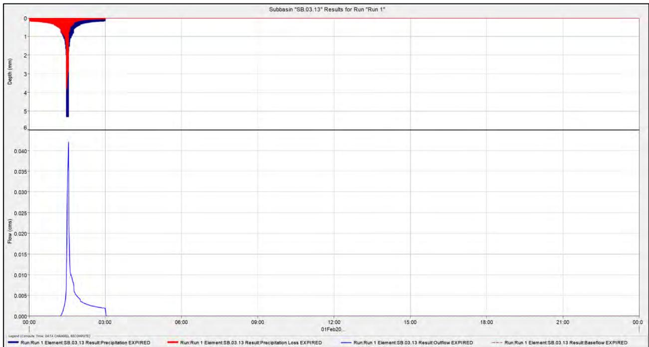
**Figura 40: letogramma di progetto e relativo idrogramma di piena del relativo sotto-bacino SB.03.13**
