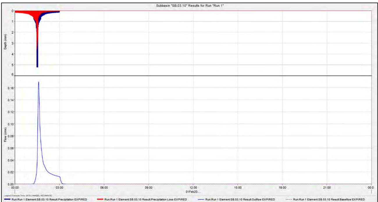
**Figura 37: letogramma di progetto e relativo idrogramma di piena del relativo sotto-bacino SB.03.10**
