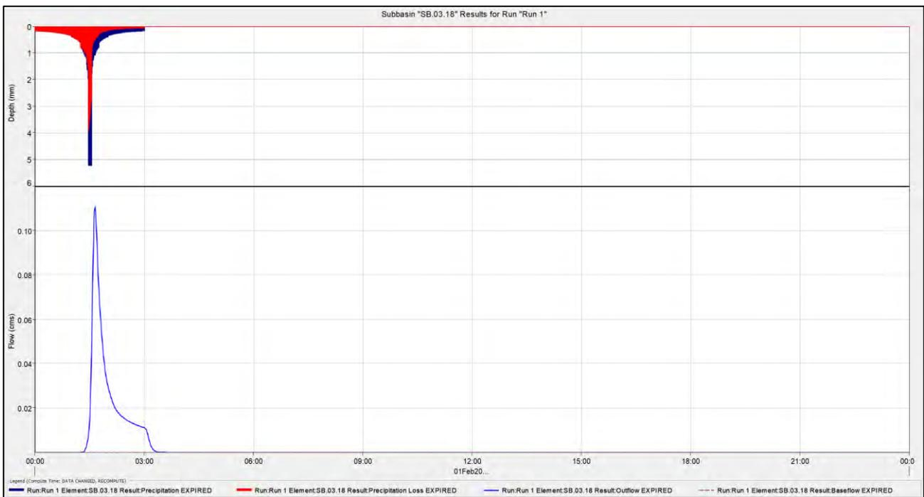
**Figura 45: letogramma di progetto e relativo idrogramma di piena del relativo sotto-bacino SB.03.18**
