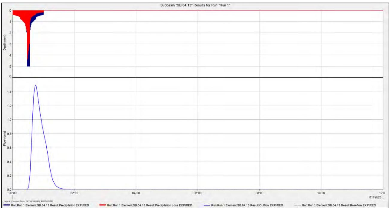
**Figura 62: Ietogramma di progetto e relativo idrogramma di piena del relativo sotto-bacino SB.04.13**
