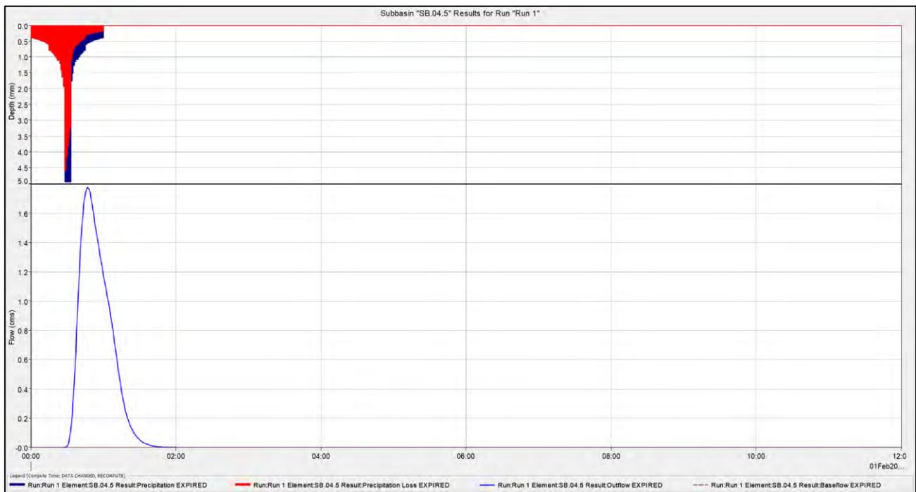
**Figura 54: letogramma di progetto e relativo idrogramma di piena del relativo sotto-bacino SB.04.5**
