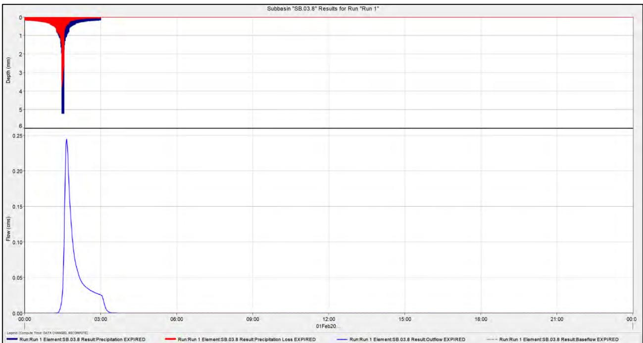
**Figura 35: letogramma di progetto e relativo idrogramma di piena del relativo sotto-bacino SB.03.8**
