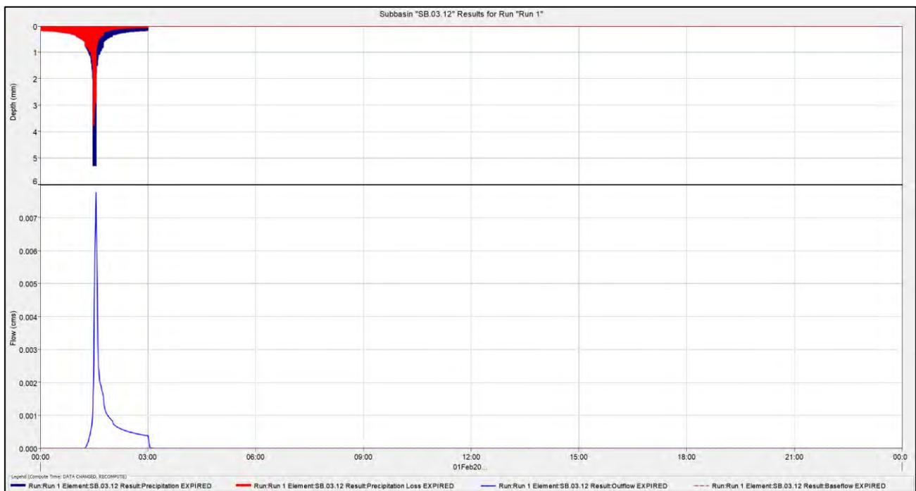
**Figura 39: Ietogramma di progetto e relativo idrogramma di piena del relativo sotto-bacino SB.03.12**
