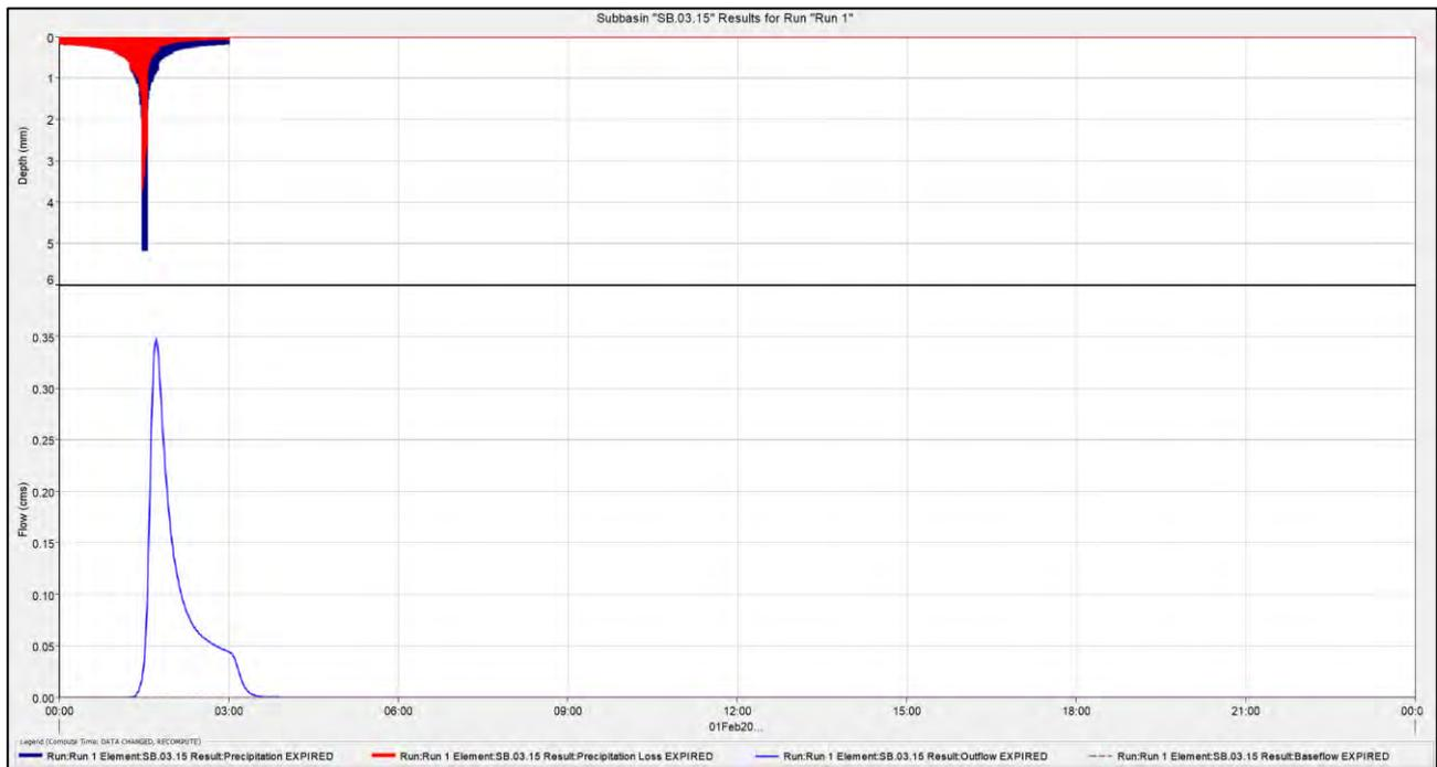
**Figura 42: letogramma di progetto e relativo idrogramma di piena del relativo sotto-bacino SB.03.15**
