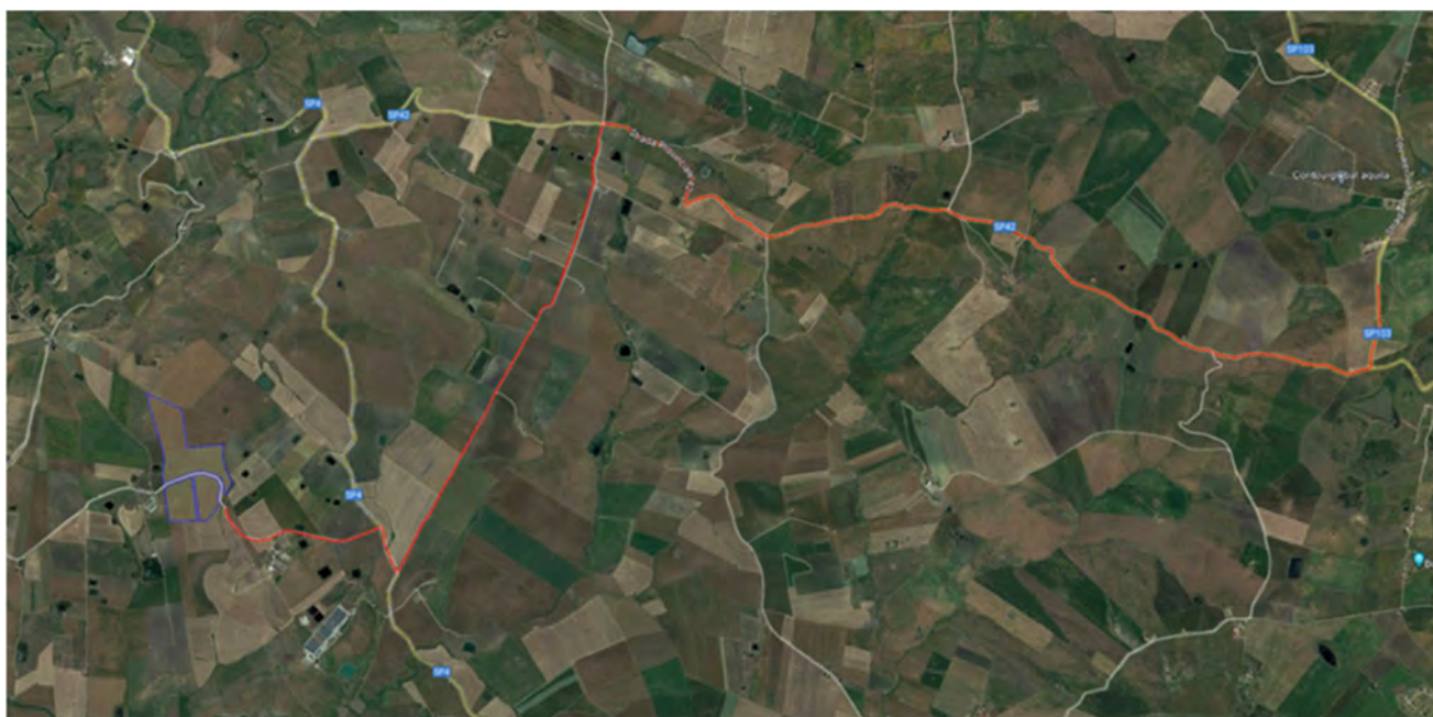
Figura 28. Cavidotto di collegamento alla SE su ortofoto
