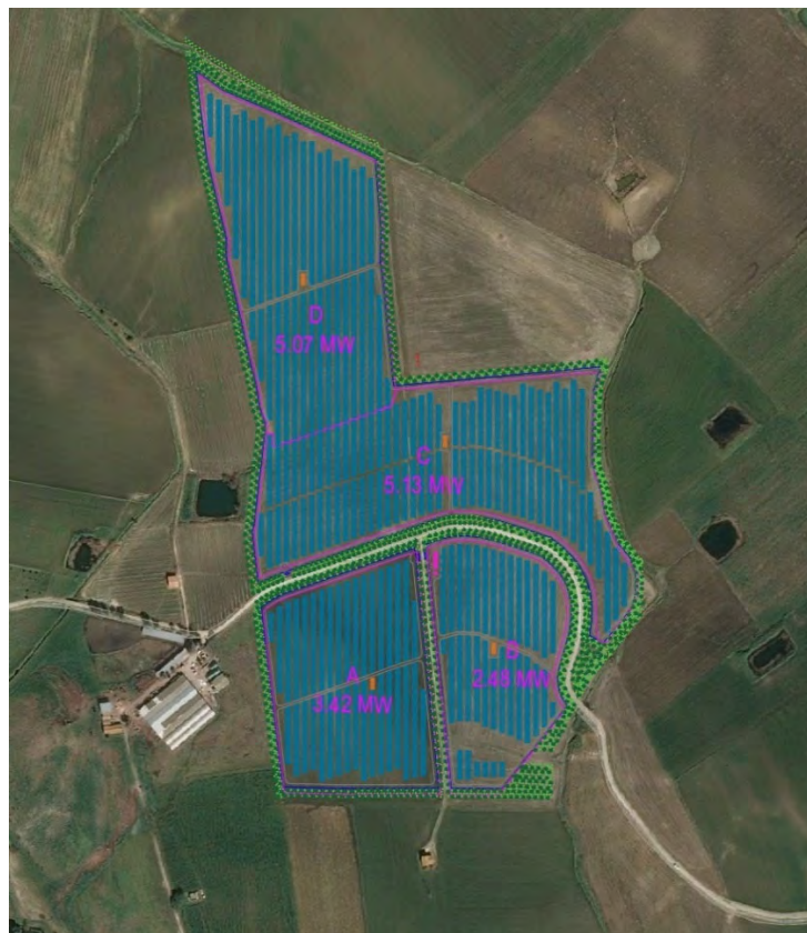
Figura 2. Suddivisione dell'impianto in sottocampi
